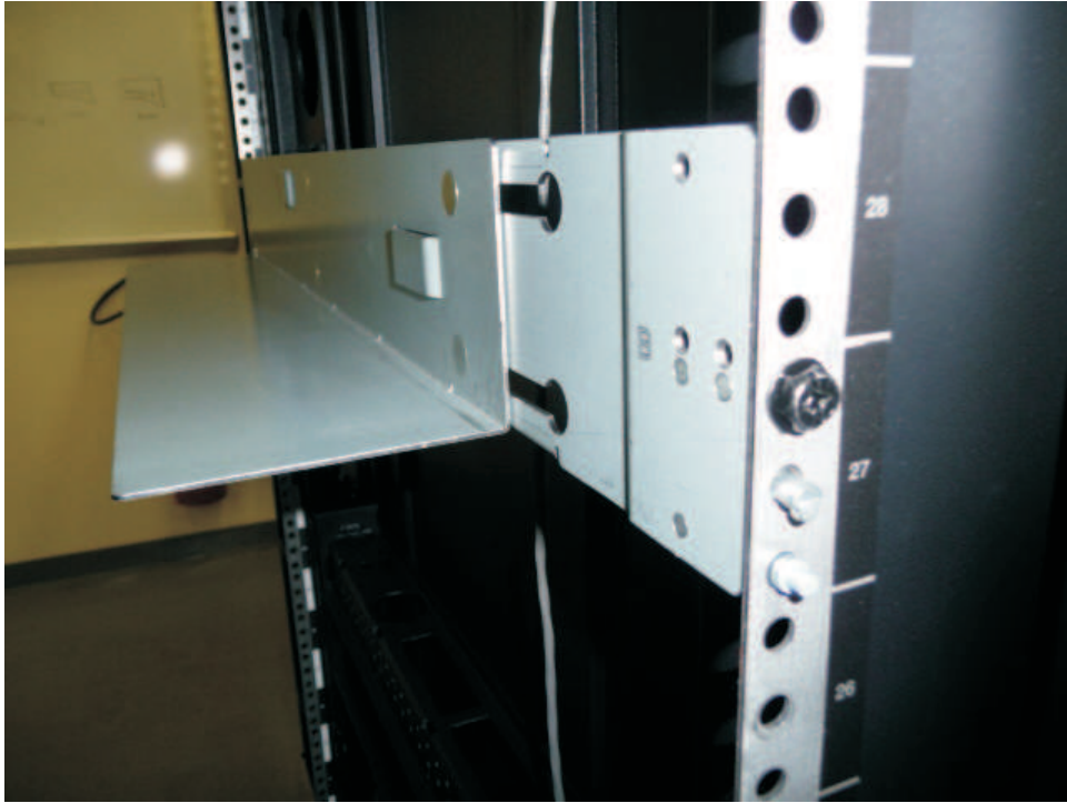
図 28. 別のマウント方法を示したラック・キット B の背面図
