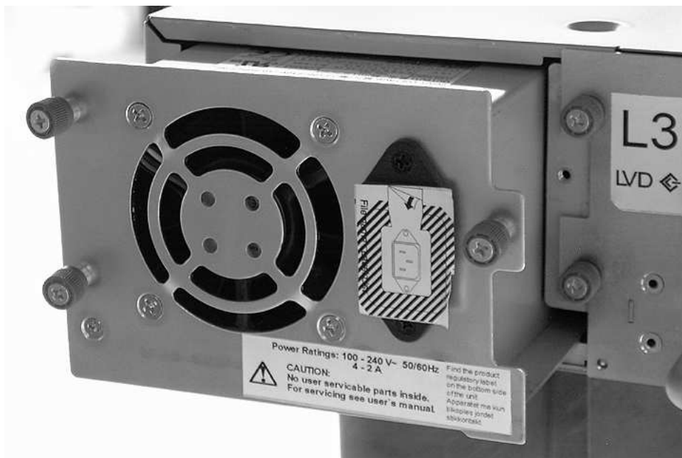
図 145. 2U ライブラリーから取り外されている電源機構
