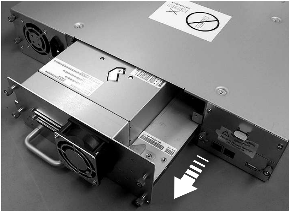
図 142. ライブラリーからのドライブ・スレッドの引き出し (ドライブ・スレッドに ESD スプリングは示されていない)
