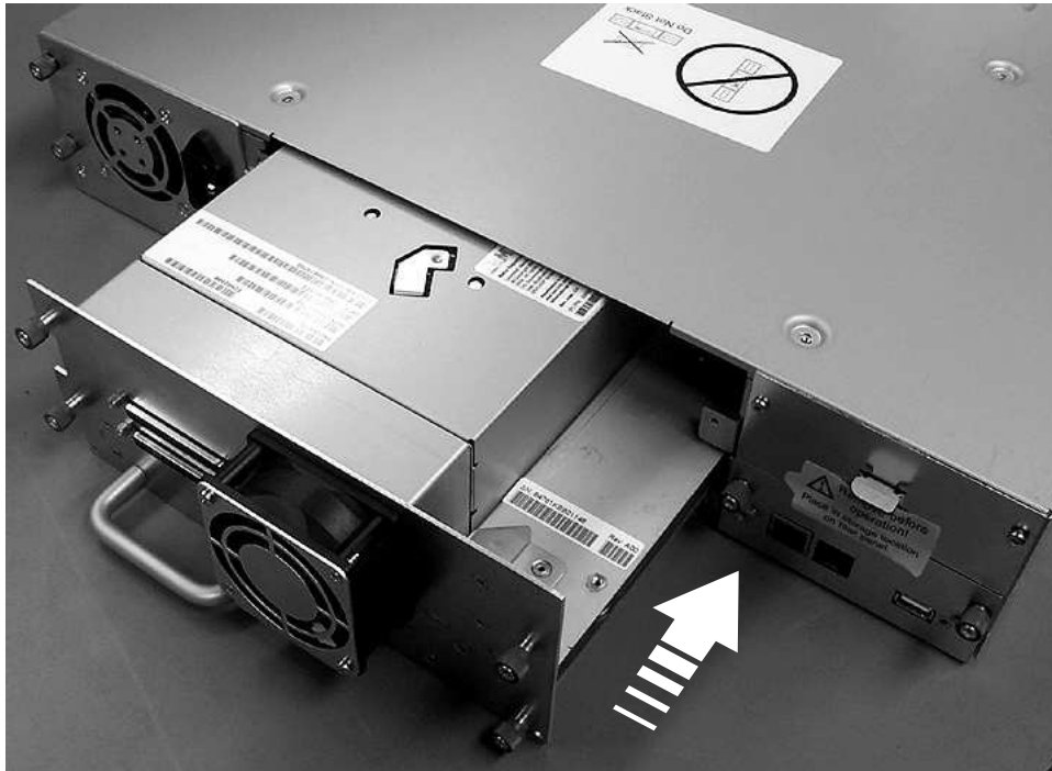
図 143. ライブラリーへのドライブ・スレッドの押し込み (ドライブ・スレッドに ESD スプリングは示されていない)
