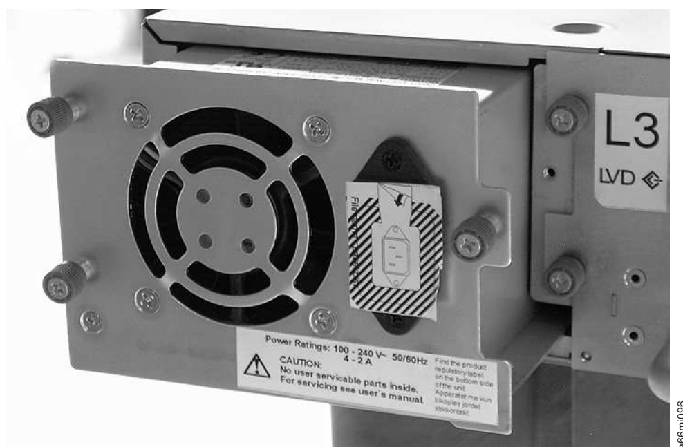
図 153. ライブラリーから取り外される電源機構
