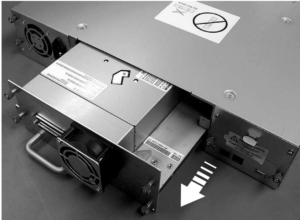
図 151. ライブラリーからのドライブ・スレッドの取り外し (ドライブ・スレッドに ESD スプリングは示されていない)
