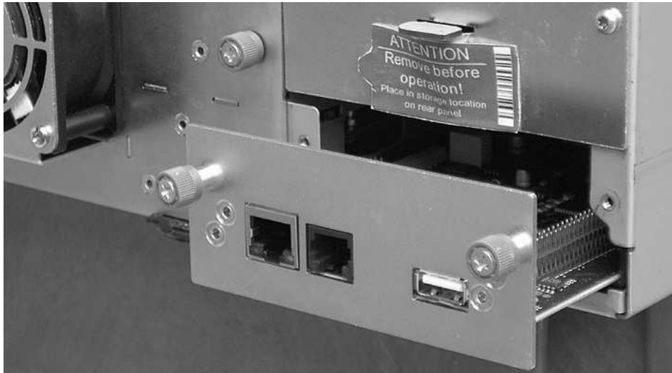
図 154. ライブラリーからのライブラリー・コントローラー・カードの取り外し
