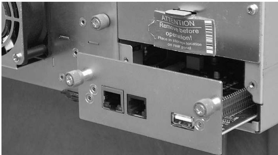
図 146. ライブラリーから取り外されているライブラリー・コントローラー・カード
