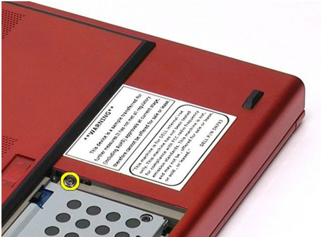
4. Drücken Sie das optische Laufwerk mit einem Schraubendreher oder einer kleinen Kunststoffspitze in Richtung der Außenkante des Computers.
