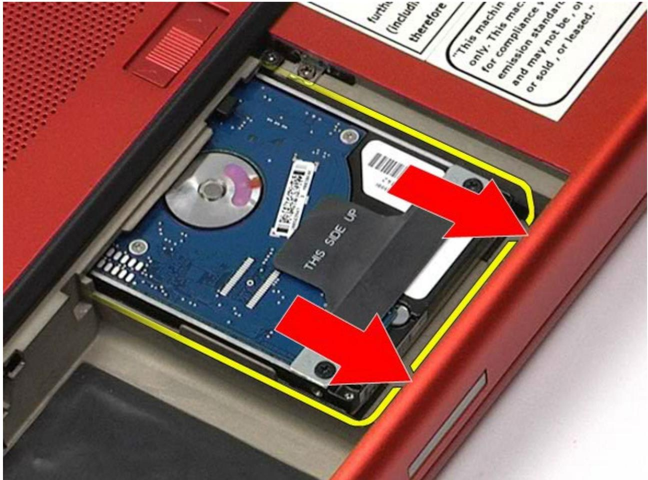
7. Heben Sie die Festplatte an der schwarzen Zugfahne nach oben und entfernen Sie sie vom Computer.
