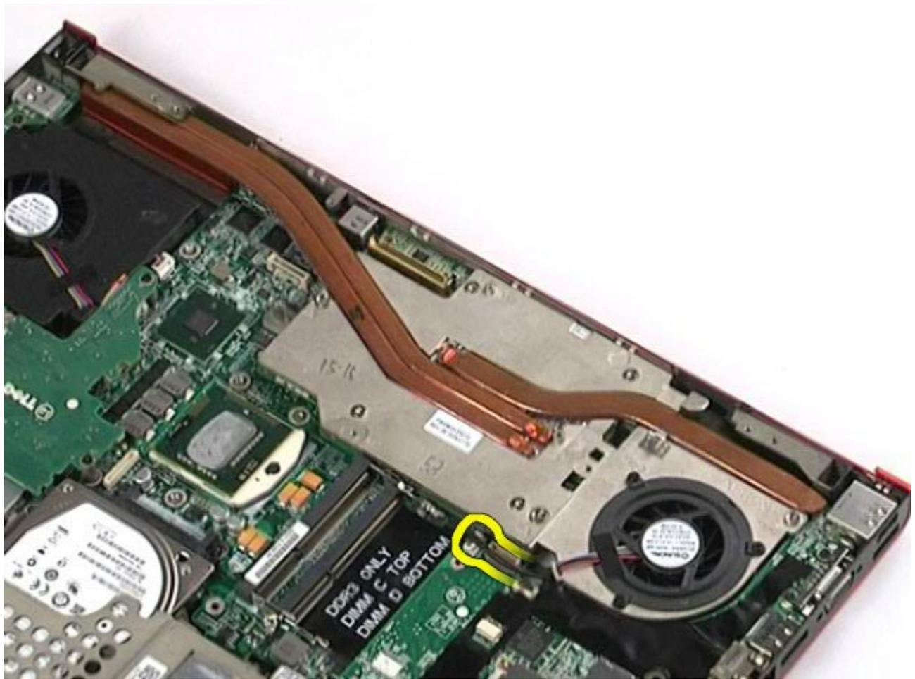
11. Lösen Sie die unverlierbaren Schrauben, mit denen die Grafikkartenbaugruppe am Computer befestigt ist.
