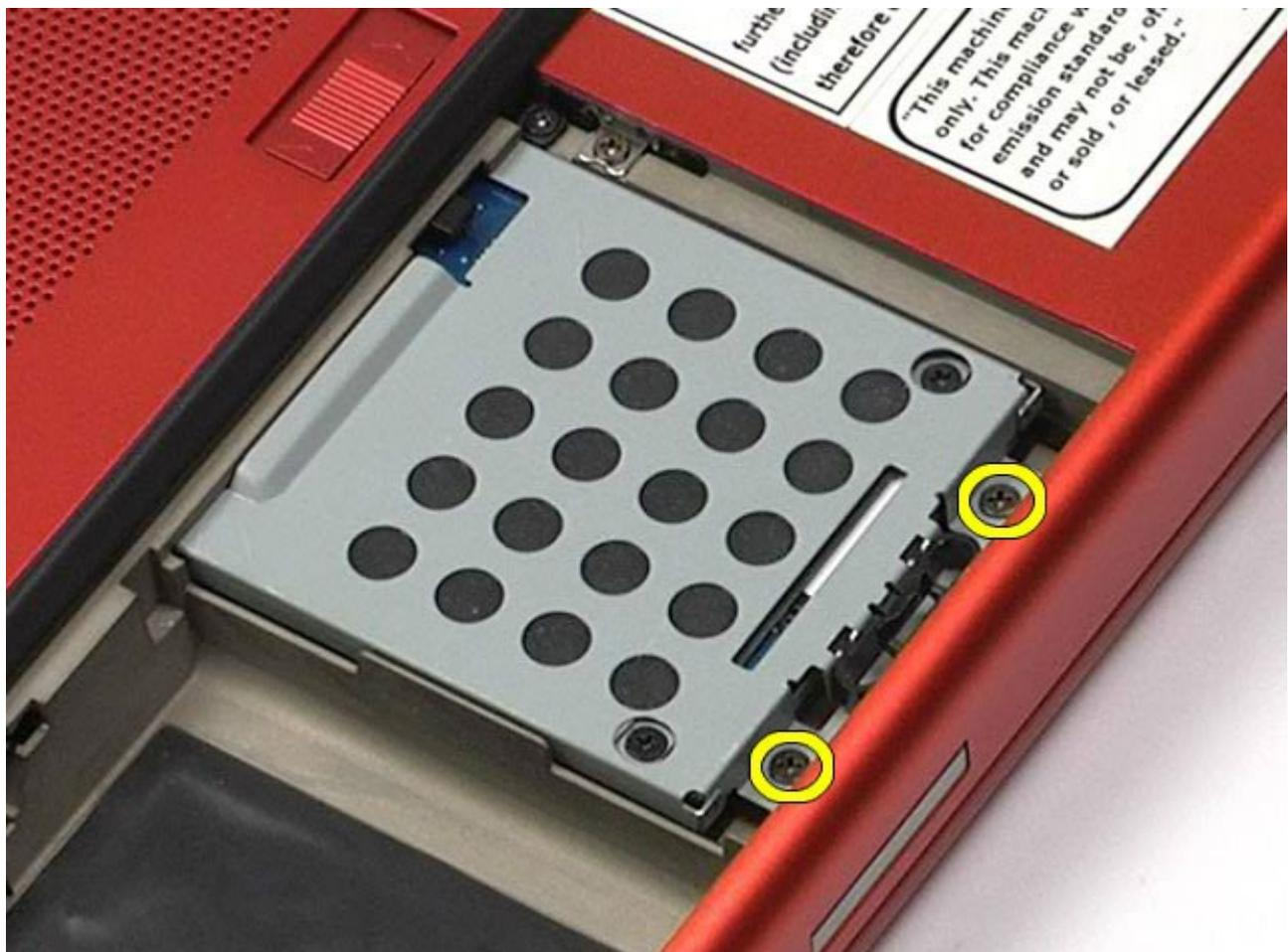
4. Ziehen Sie an der Sperrklinke, um den Laufwerkträger vom Computer zu lösen.
