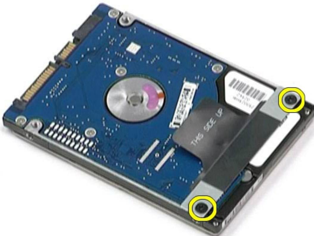
9. Entfernen Sie die Halterung der schwarzen Zugfahne vom Laufwerk.
