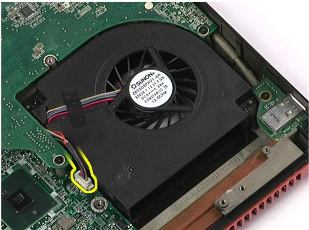
12. Entfernen Sie die Schrauben, mit denen der Lüfter am Computer befestigt ist.
