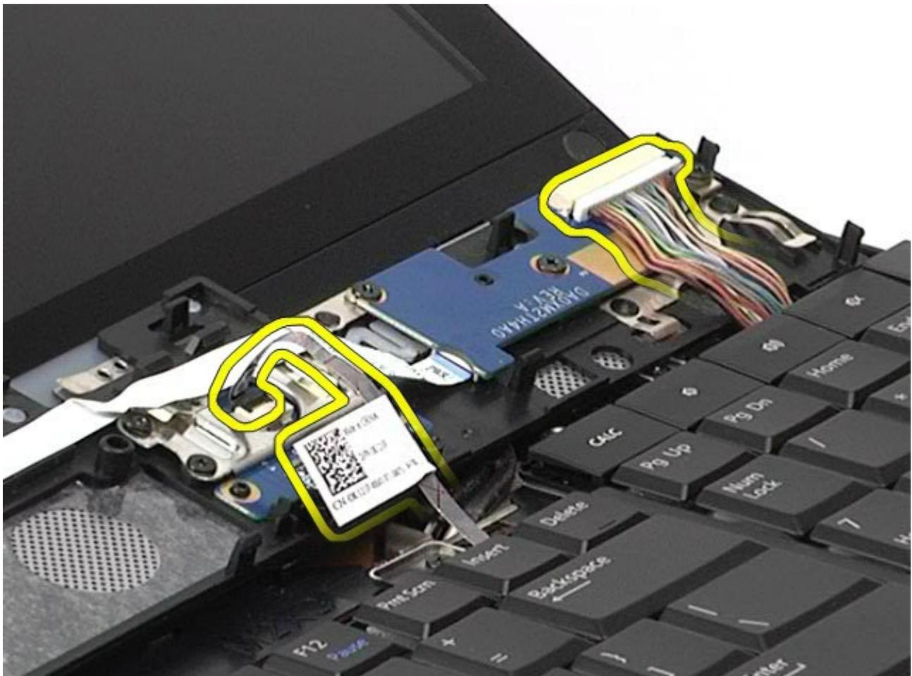
6. Entfernen Sie die Scharnierabdeckung vom Computer.
