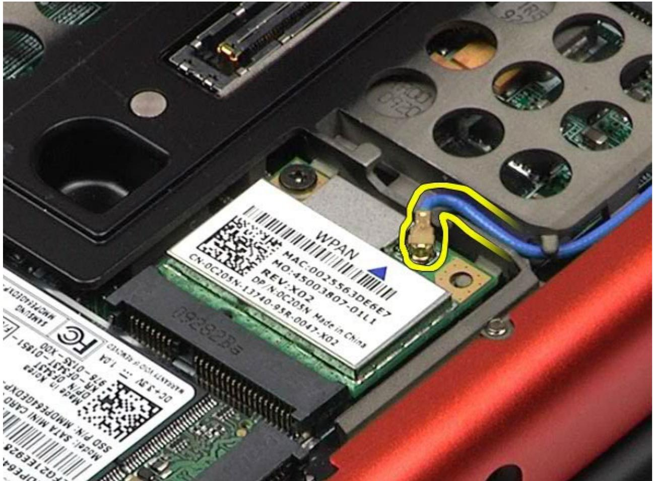
5. Entfernen Sie die Schraube, mit der die Karte am Computer befestigt ist. Die Karte klappt in einem 45-Grad-Winkel nach oben.
