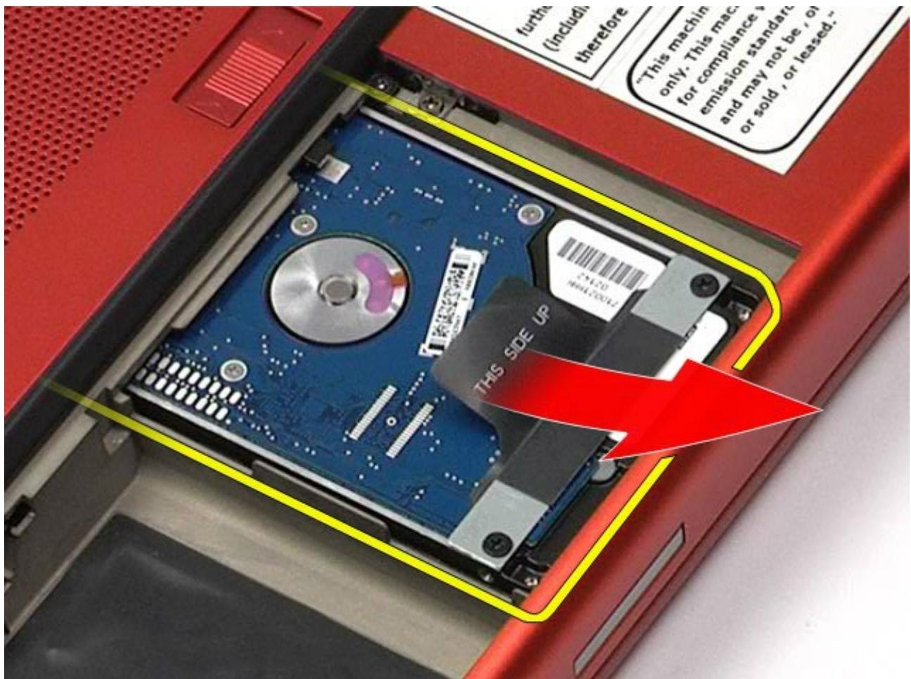
8. Entfernen Sie die Schrauben, mit denen die Halterung der schwarzen Zugfahne am Laufwerk befestigt ist.
