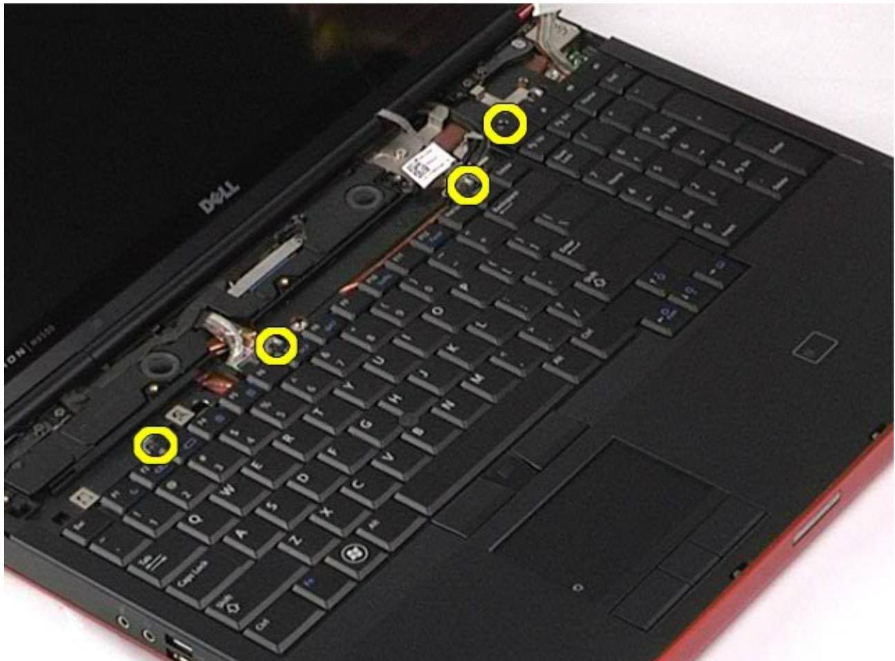
5. Schieben Sie die Tastatur in Richtung des Displays, um sie von der Systemplatine zu trennen.
