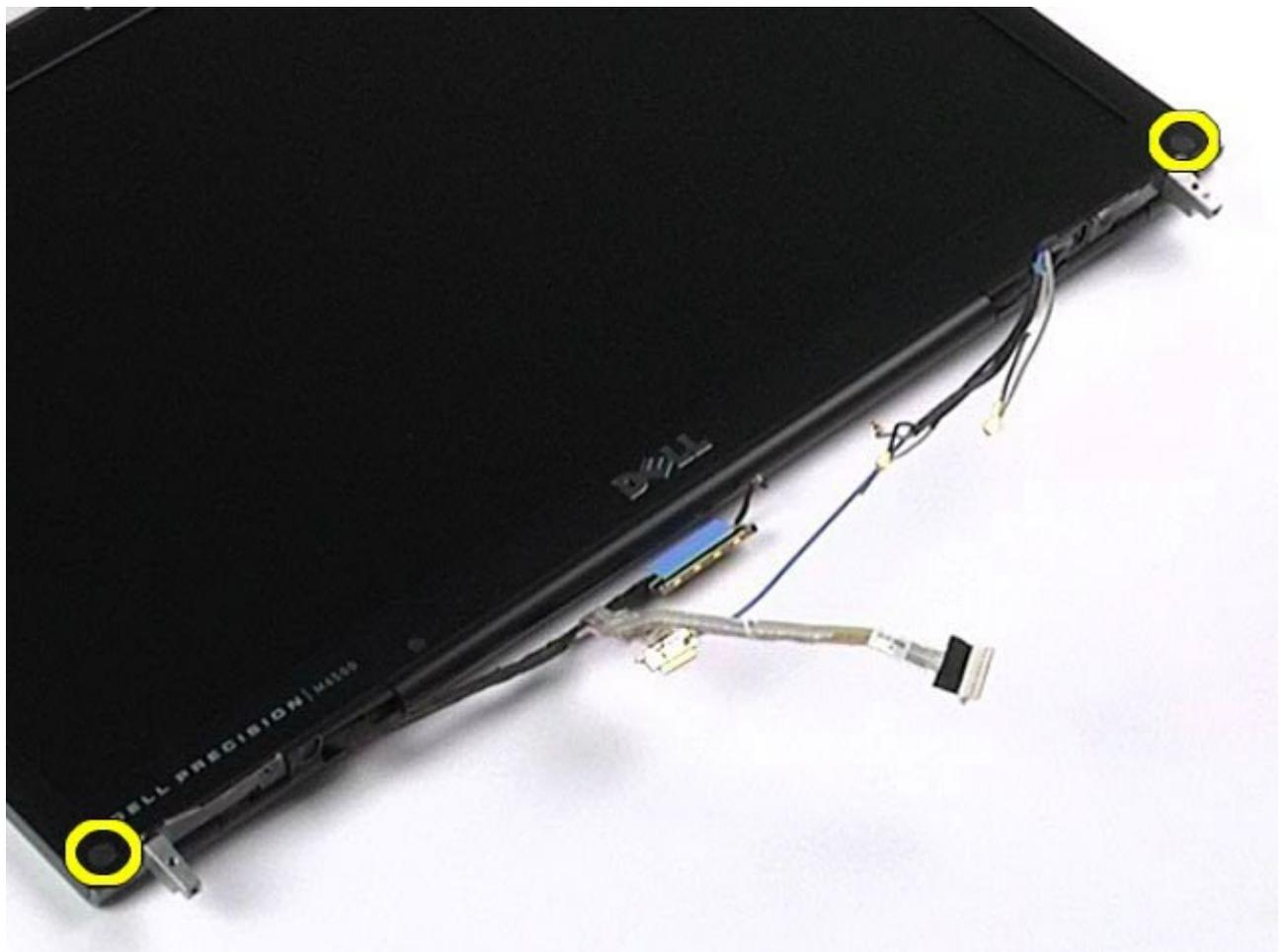
8. Entfernen Sie die Schrauben, mit denen der Displayrahmen an der Displayeinheit befestigt ist.
