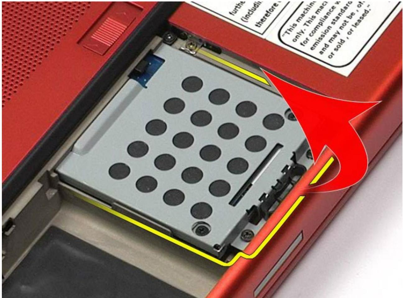
5. Entfernen Sie den Laufwerkträger vom Computer.
