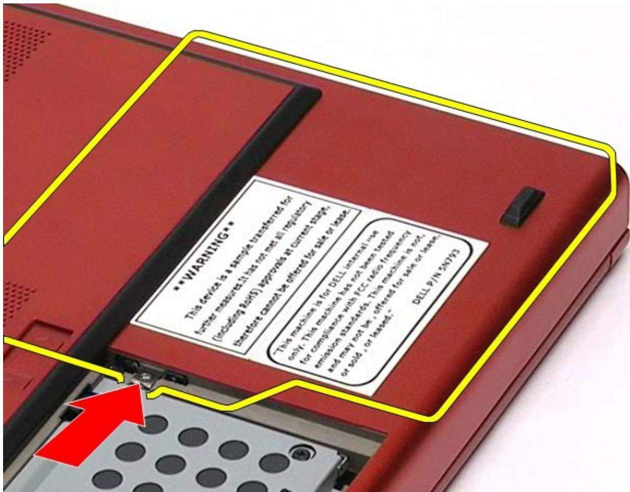
5. Ziehen Sie das optische Laufwerk aus dem Laufwerkschacht und entfernen Sie es vom Computer.
