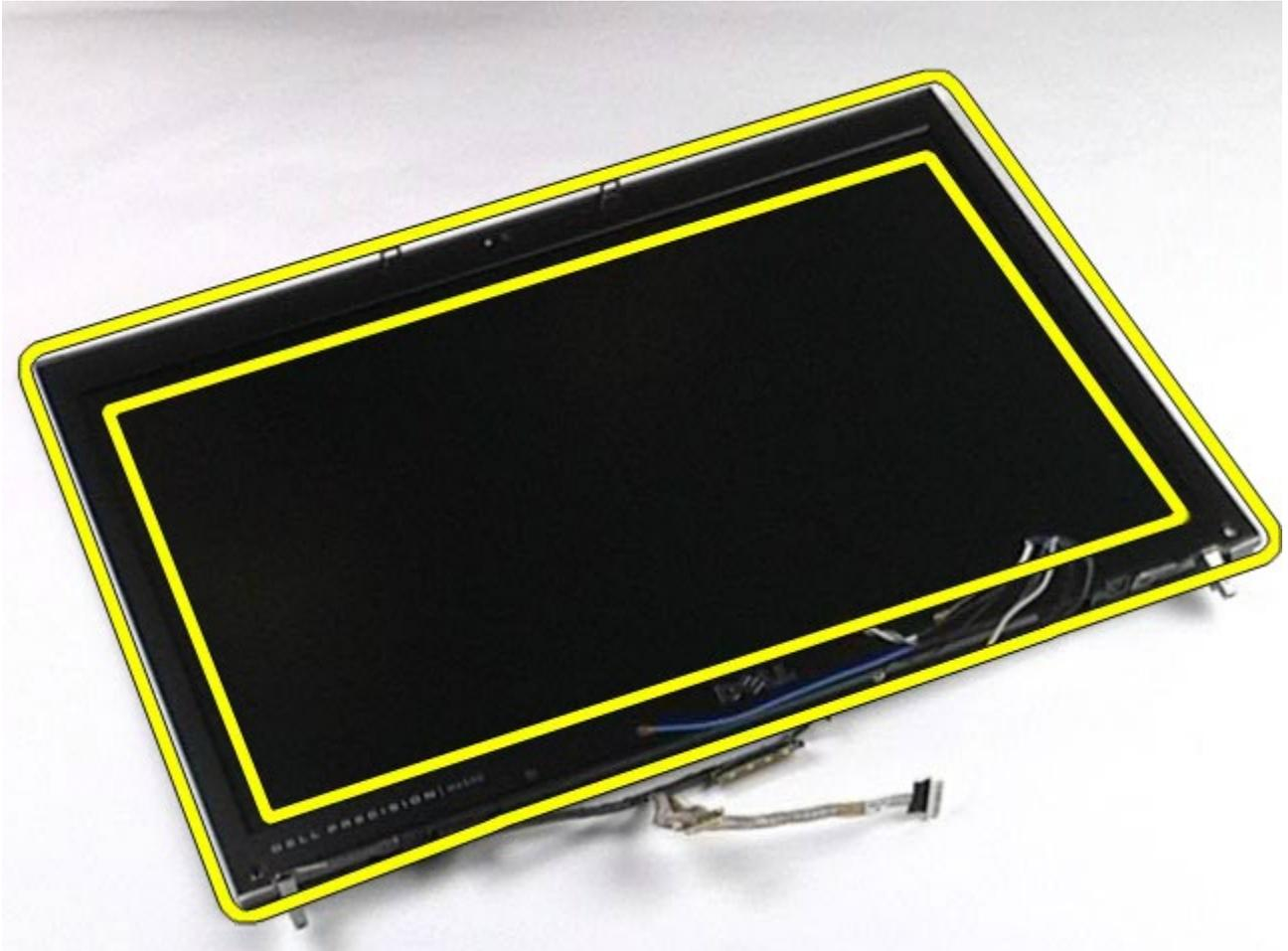
10. Entfernen Sie den Displayrahmen von der Displayeinheit.
