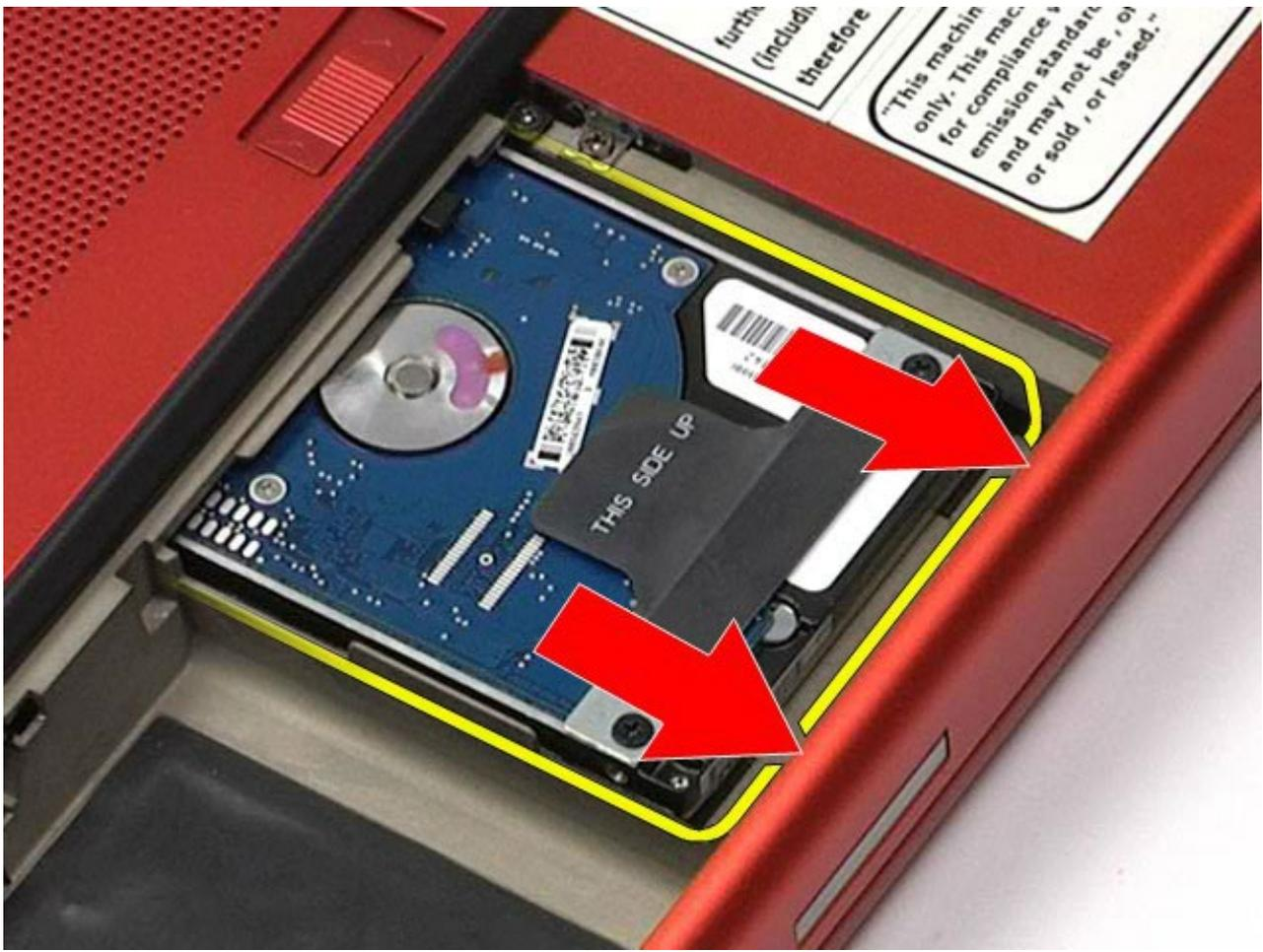
7. 使用黑色拉片向上提起硬碟機，將其從電腦中卸下。
