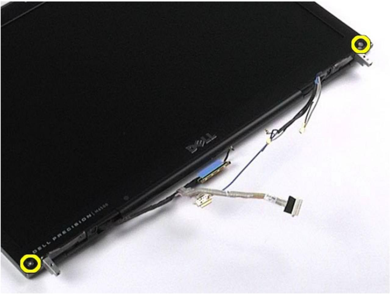
9. 將手指伸入顯示器前蓋與顯示板邊緣之間，將顯示器前蓋從顯示板輕輕撬起。
