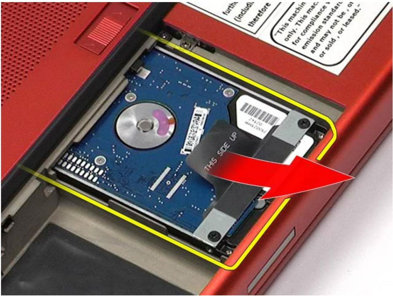
8. 卸下將黑色拉片軸固定至硬碟機的螺絲。
