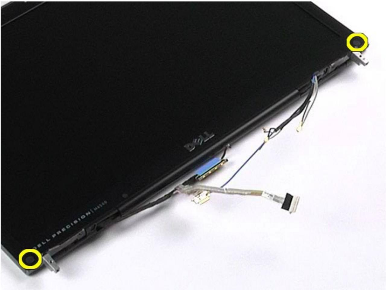
8. 卸下將顯示器前蓋固定至顯示板的螺絲。
