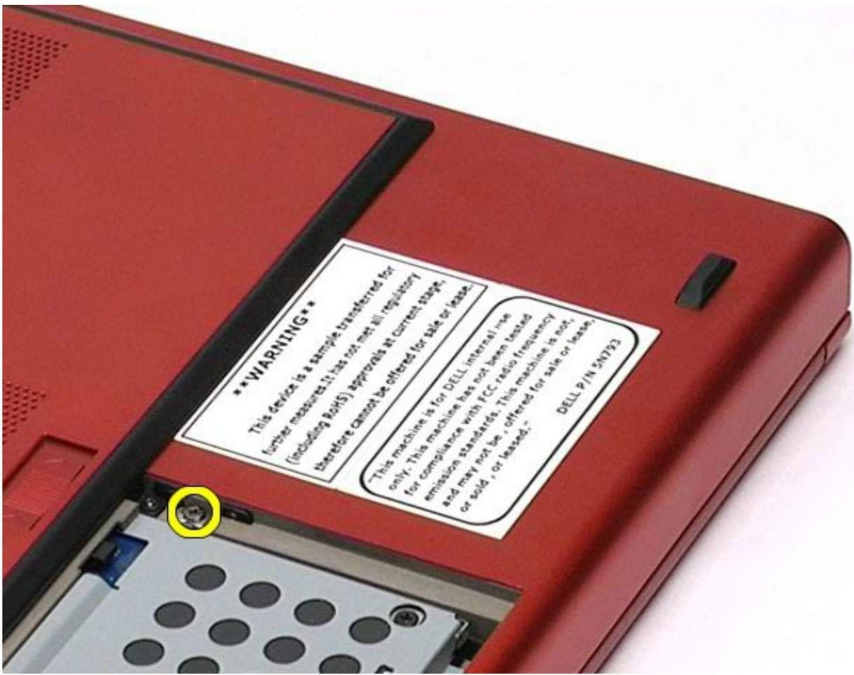
4. 使用螺絲刀或小塑料划片，將光碟機一點點朝電腦外側邊緣移動。
