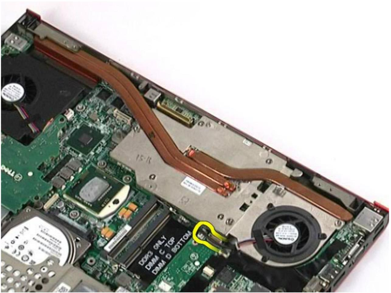
11. 鬆開將影像卡組件固定到電腦的緊固螺絲。
