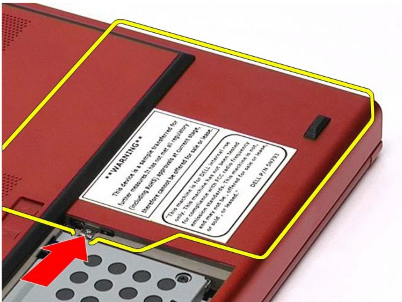
5. 將光碟機從光碟機槽拉出，將其從電腦中卸下。
