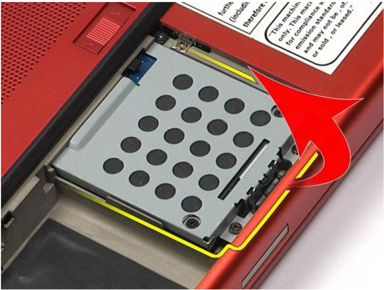
5. 從電腦中卸下硬碟機固定框架。
