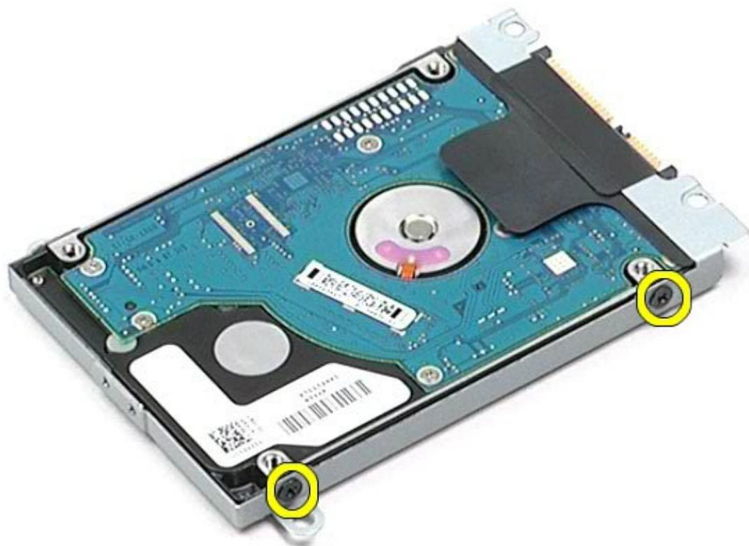
7. 從硬碟機上卸下硬碟機托架。
