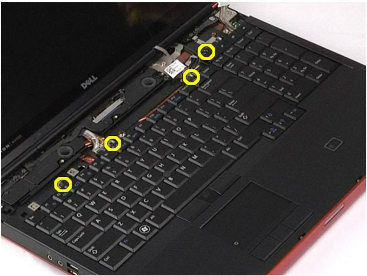
5. 將鍵盤朝顯示器方向滑動，斷開鍵盤與主機板的連接。
