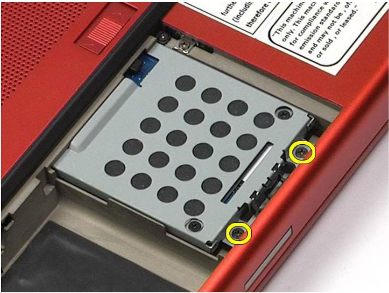
4. 拉動釋放彈片，使硬碟機固定框架從電腦中釋放。
