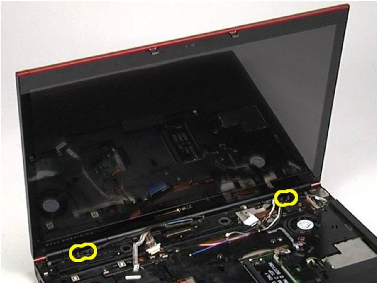
16. Demontați ansamblul ecranului din computer.
