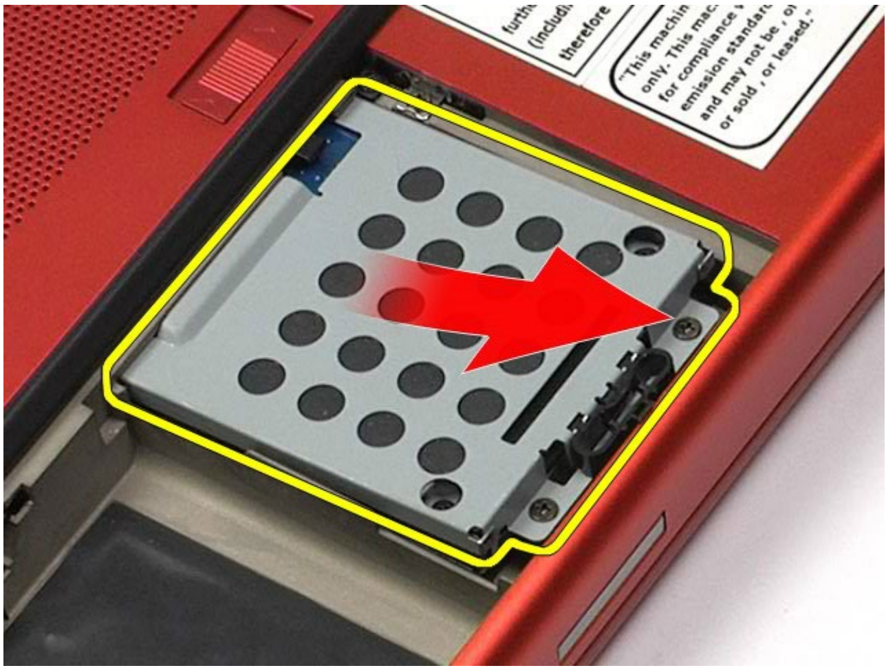
6. Glisați hard disk-ul din calculator.
