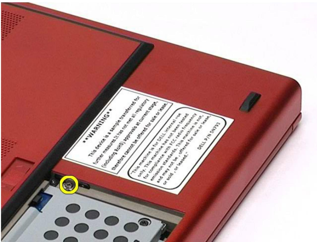
4. Utilizando uma chave de parafusos ou um instrumento aguçado em plástico, empurre suavemente a unidade óptica em direcção à extremidade externa do computador.
