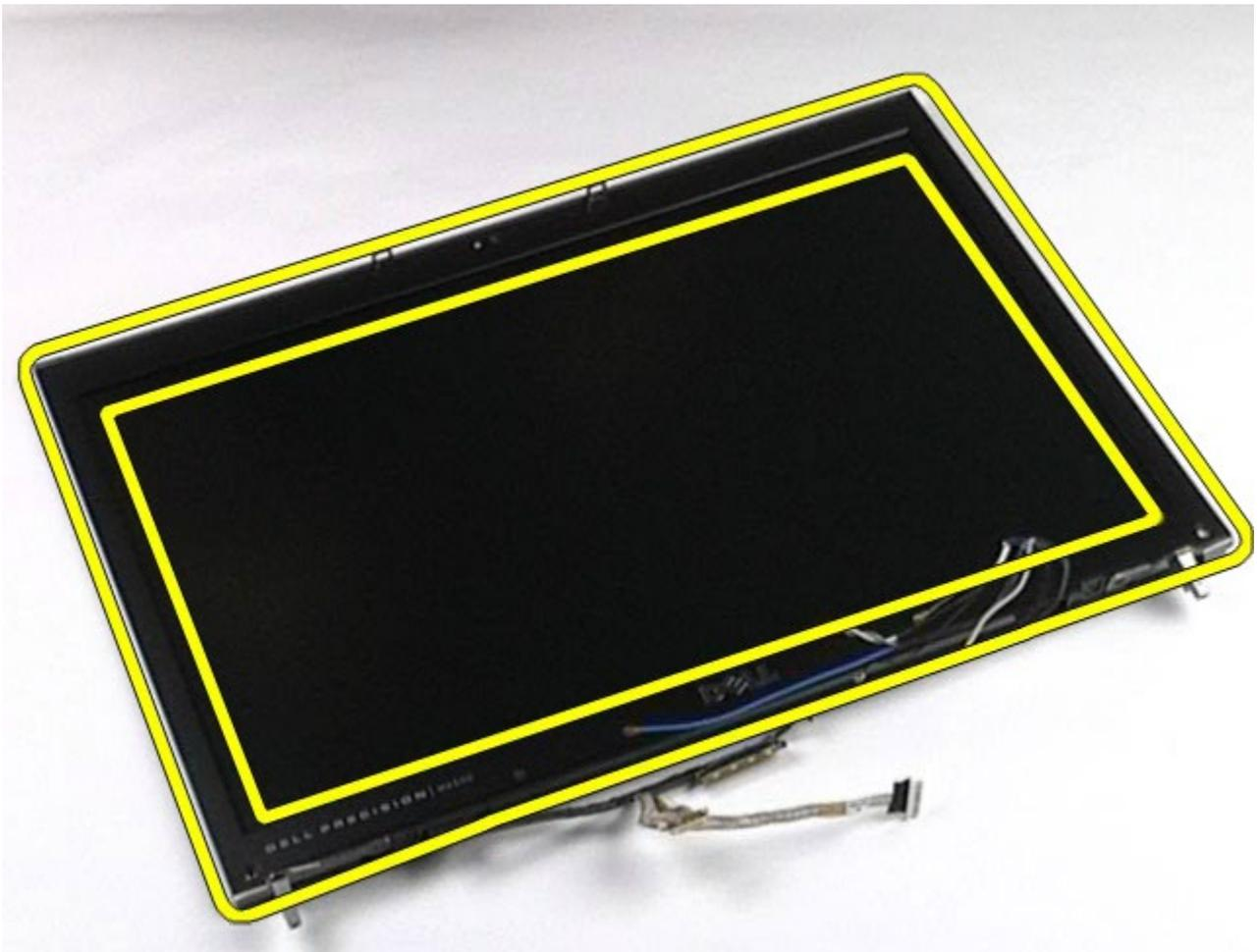
10. Retire a moldura do monitor do painel do monitor.
