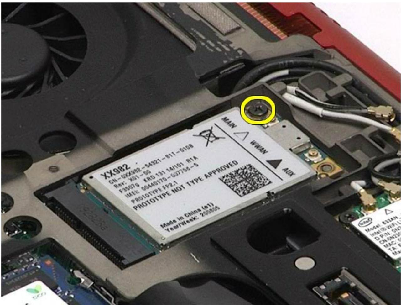
6. Faça deslizar a placa WWAN para fora do conector na placa de sistema.
