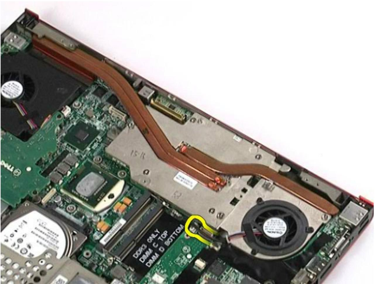
11. Desaperte os parafusos integrados que fixam a montagem da placa de vídeo ao computador.
