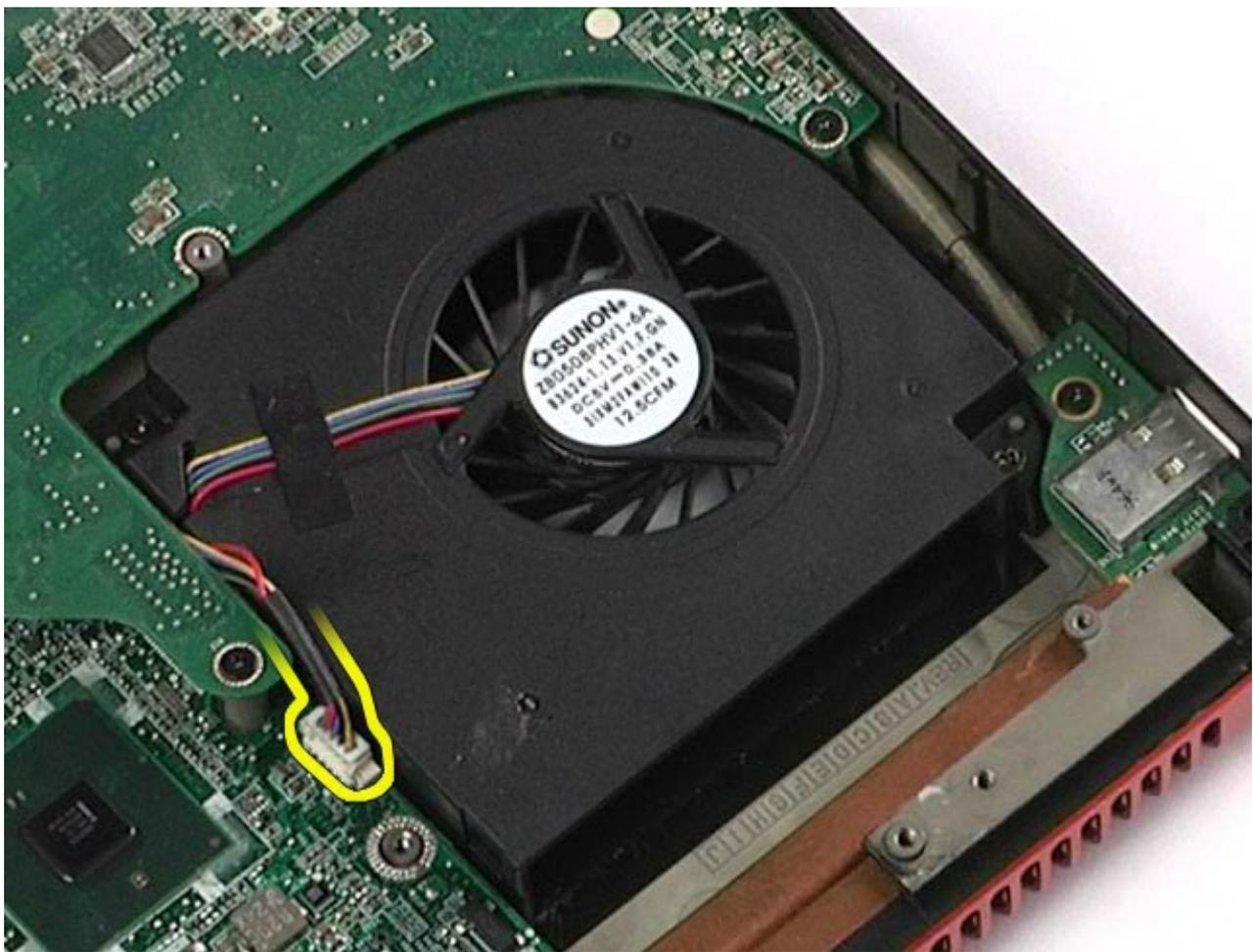
12. Retire os parafusos que fixam o ventilador ao computador.
