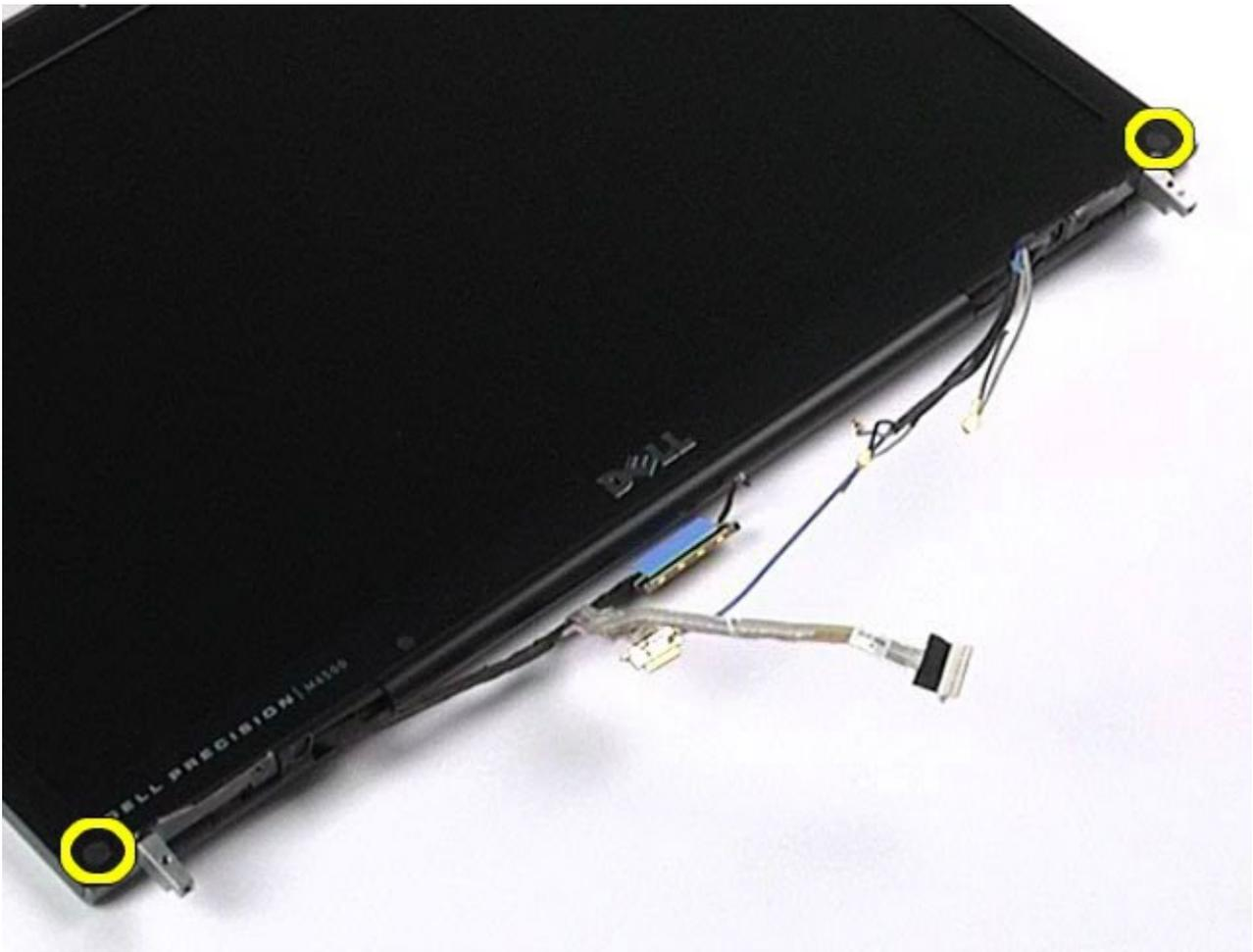
8. Retire os parafusos que fixam a moldura do monitor ao painel do monitor.
