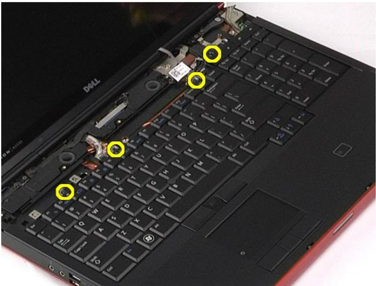
5. Faça deslizar o teclado na direcção do monitor para desligá-lo da placa de sistema.
