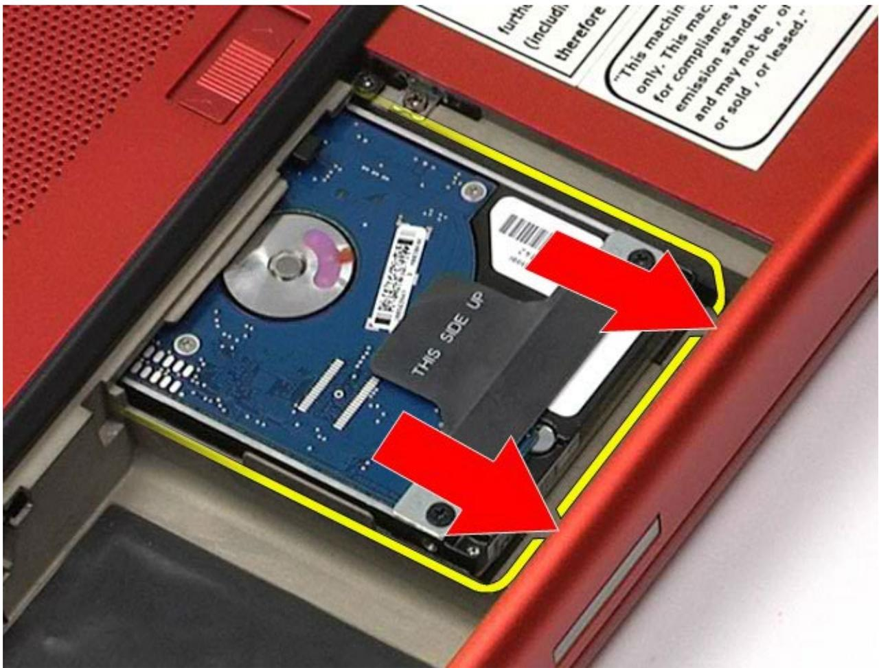
7. Utilizando a patilha preta, levante a unidade de disco rígido e retire-a do computador.
