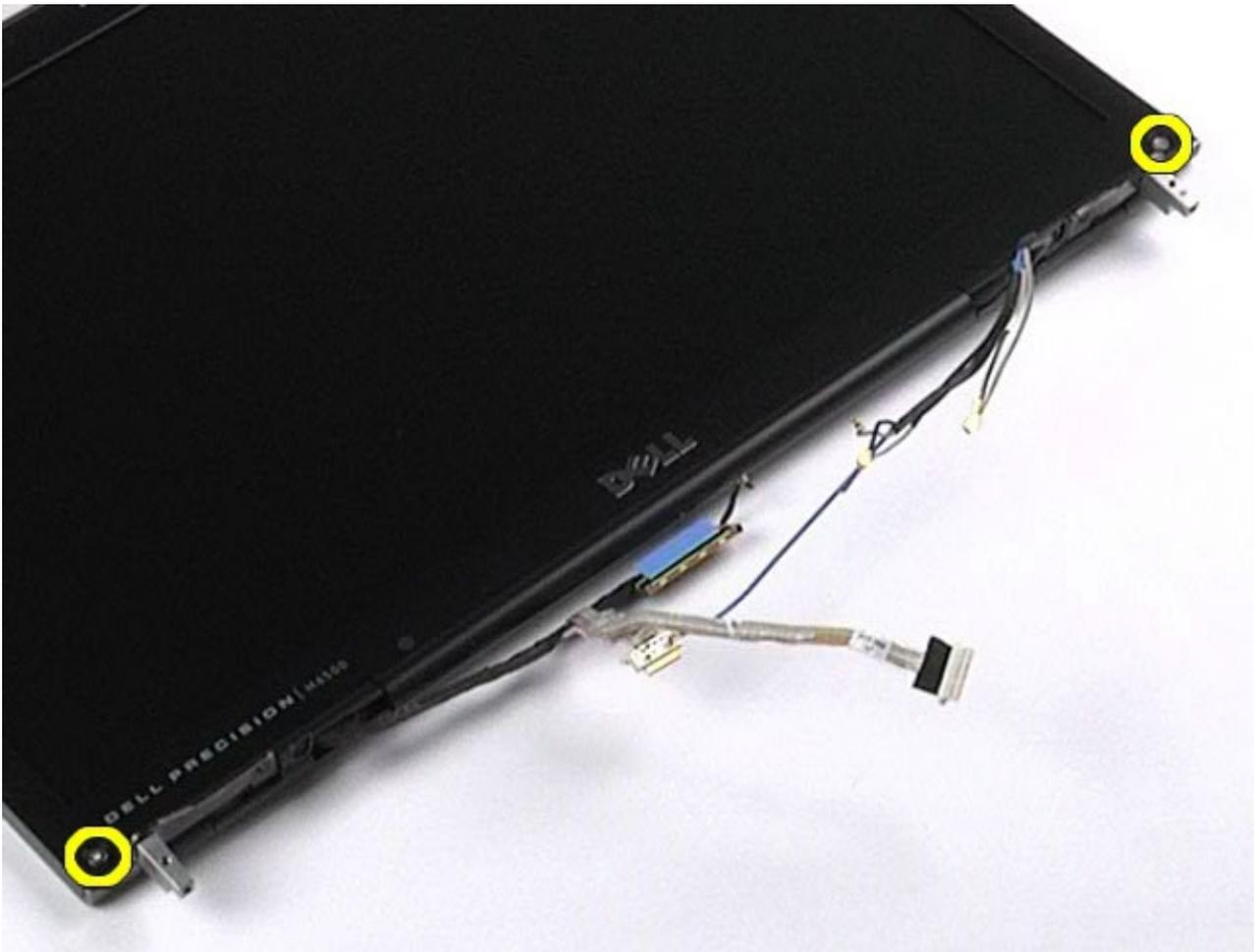
9. Afaste suavemente a moldura do monitor do painel do monitor, fazendo rodar os seus dedos entre a extremidade da moldura e o painel do monitor.
