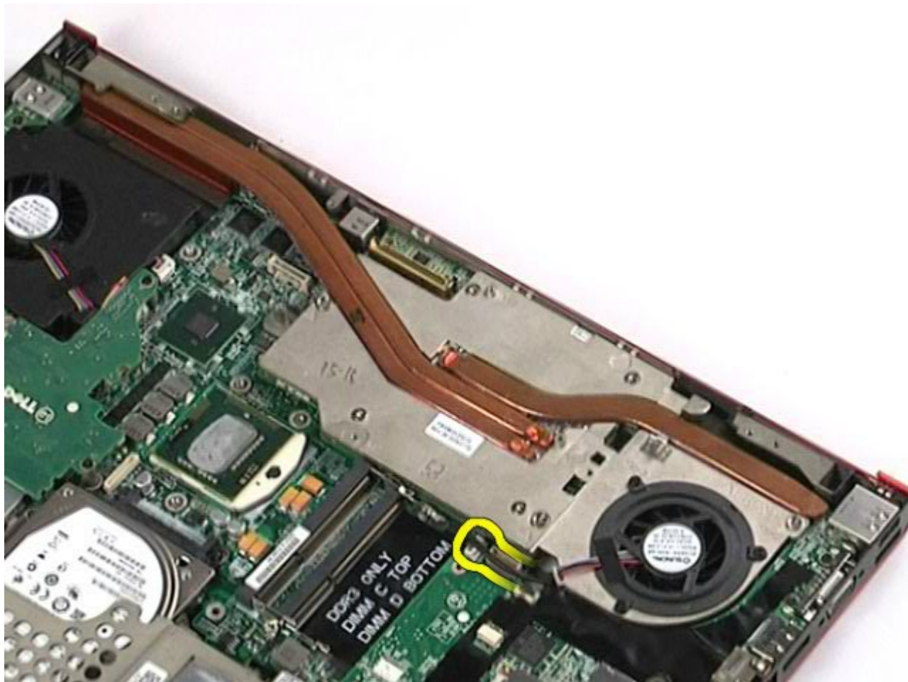
11. Povolte jisticí šrouby, které připevňují sestavu grafické karty k počítači.
