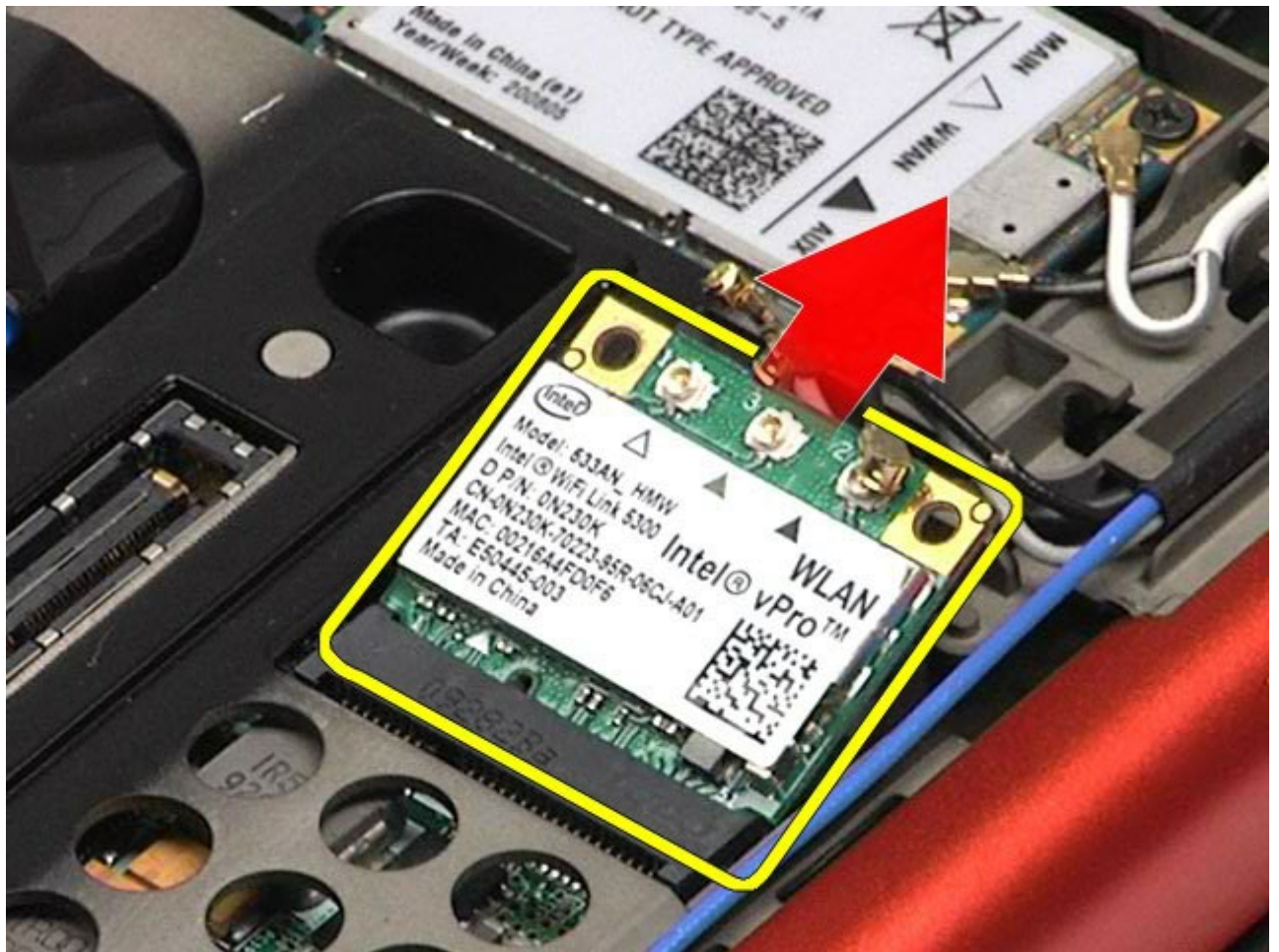
6. قم بسحب بطاقة WLAN خارج منفذ التوصيل الموجود على لوحة النظام.
