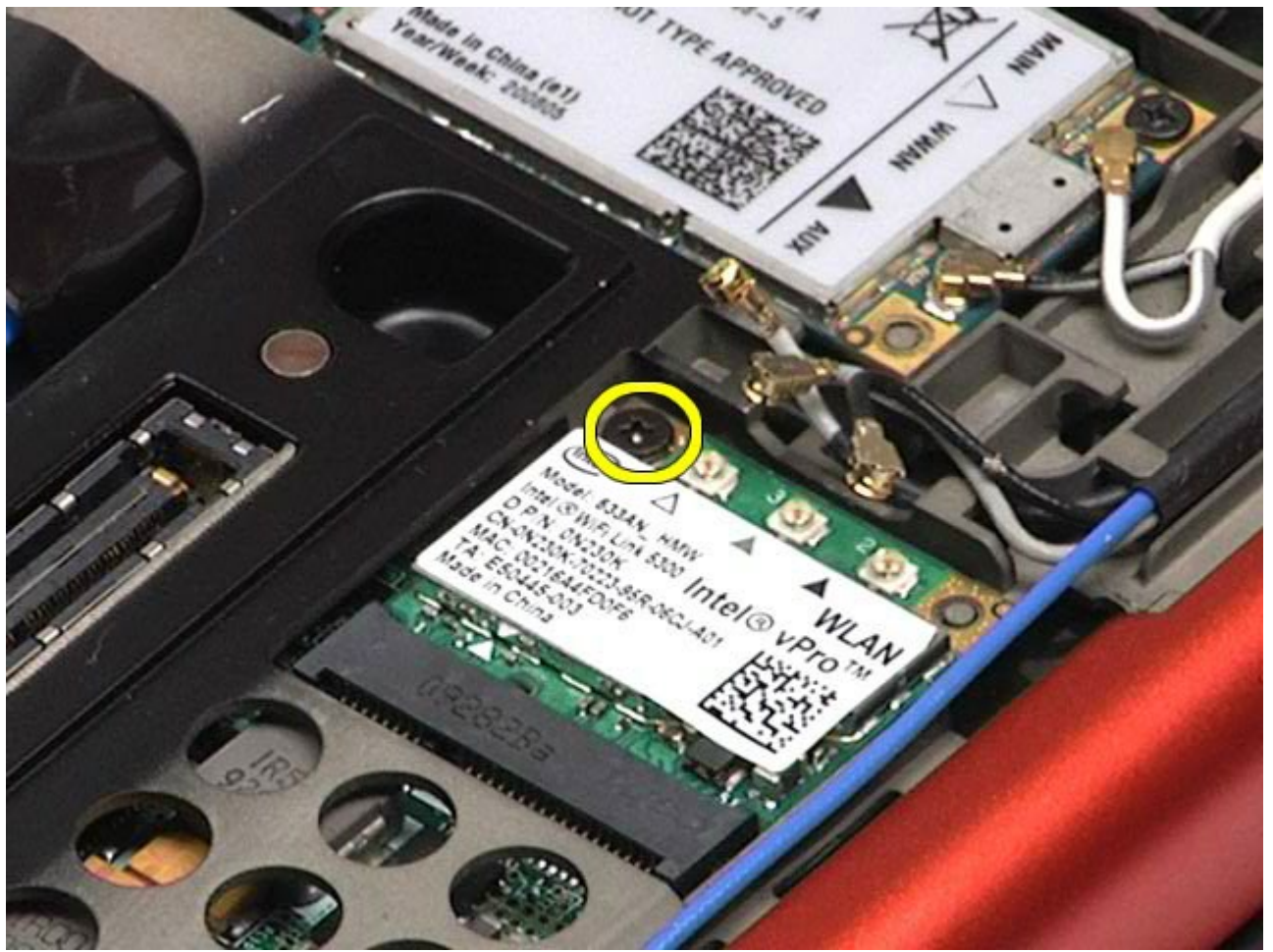
6. قم بسحب بطاقة WLAN خارج منفذ التوصيل الموجود على لوحة النظام.
