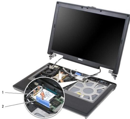
1 天线电缆 (2) 2 显示屏电缆推拉卡舌
