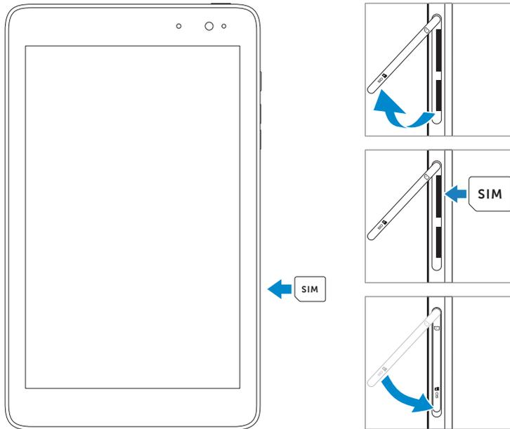
**⚠ VORSICHT:** Wenn eine nicht kompatible SIM-Karte (z. B. eine nano-SIM-Karte) in den micro-SIM-Kartensteckplatz eingesetzt wird, können sowohl die Karte und die darauf befindlichen Daten als auch das Tablet beschädigt werden.
