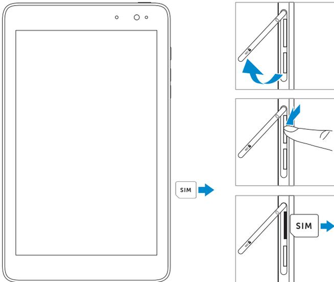
**⚠ VORSICHT:** Wird die micro-SIM-Karte herausgenommen, wenn das Tablet eingeschaltet ist, können die Karte und die darauf befindlichen Daten beschädigt werden. Stellen Sie sicher, dass das Tablet ausgeschaltet ist oder die Netzwerkverbindungen deaktiviert sind.
