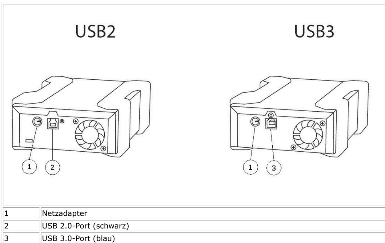
Der USB-Bus teilt die verfügbare Bandbreite unter allen an den Systemen angeschlossenen USB-Geräten auf, einschließlich des externen RD1000-Laufwerks. Der Gebrauch von Kameras, Flash-Speichergeräten usw. mit dem USB-Bus kann die Geräteleistung mindern. Trennen Sie alle nicht benötigten Geräte.
