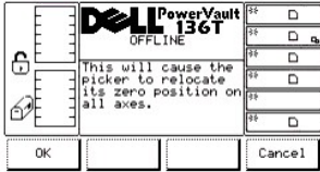
图 104. 维修 > 磁带库 > 诊断 > 机械手 > 原始位置对话框
