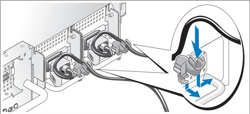
Prenda o suporte de retenção do cabo de alimentação na dobra direita da alça da fonte de alimentação. Faça um laço no cabo de alimentação, conforme mostrado na ilustração, e prenda-o ao gancho localizado no suporte.
