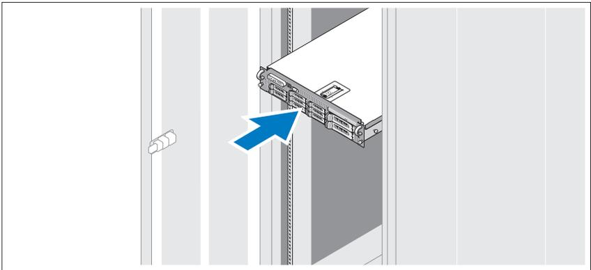
Monte los rieles e instale el sistema en el estante siguiendo las instrucciones de seguridad y de instalación en estante que venían con el sistema.
