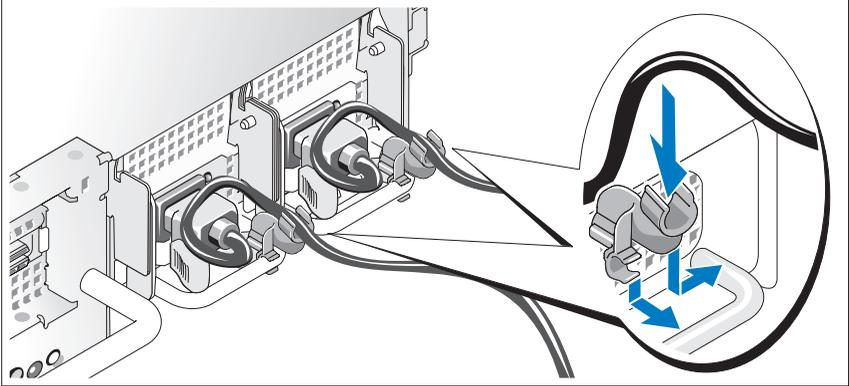
Fixez le support du câble sur la courbe droite de la poignée du bloc d'alimentation. Faites une boucle comme indiqué dans l'illustration et insérez le câble d'alimentation dans le clip du support.
