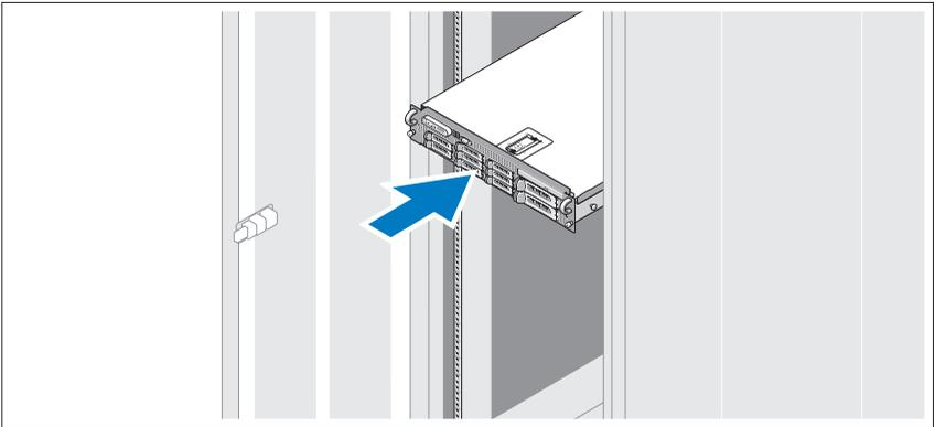
Assemblez les rails et installez le système dans le rack en suivant les consignes de sécurité et les instructions pour l'installation du rack fournies avec votre système.
