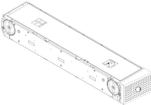
Der Autoloader wird nicht ausführen, es sei denn, dass beide Magazinschächte entweder mit einem Magazin oder einem Leermagazin richtig besetzt sind. Eine Methode zum Schließen der Öffnungen ist die Verwendung von zwei Magazinen. Wenn Sie nur ein Magazin verwenden, dann müssen Sie die andere Magazinöffnung mit einem Leermagazin füllen, damit das Gerät betriebsbereit werden kann.
