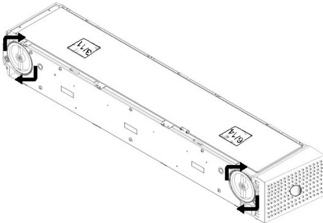
Lassen Sie das Magazin nicht rotieren, Ihre Hand einfügend und die Kassette-Träger stoßend. Sie können die Öffnungen im Magazin verwenden, um Kassetten von den acht Steckplätzen innerhalb jedes Magazins zu laden und zu entladen.
