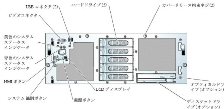
表 1-2 正面パネルの LED インジケータ、ボタン、およびコネクタ
