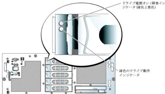
表 1-3 に、ドライブインジケータのパターンの一覧を示します。システムでドライブイベントが発生すると、さまざまなパターンで表示されます。たとえば、ハードドライブが故障すると、「ドライブ障害」のパターンが表示されます。取り外しのためにドライブを選択した後、「ドライブ取り外し準備中」のパターンが表示され、その後、「ドライブの挿入または取り外し可」のパターンが表示されます。交換用ドライブの取り付け後、「ドライブの動作準備中」を示すパターンが表示され、次に「ドライブオンライン」を示すパターンが表示されます。
