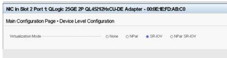
Figura 8-9. Configuração do sistema para SR-IOV: Dispositivos integrados
