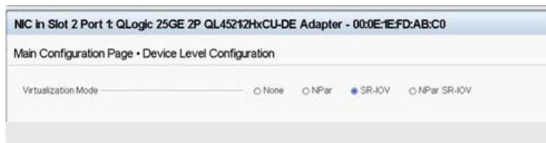
Figura 8-2. Configuração do sistema para SR-IOV: Configuração do nível do dispositivo
