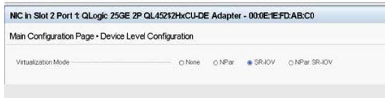
그림 8-9. SR-IOV 를 위한 시스템 설정 : 통합 장치
