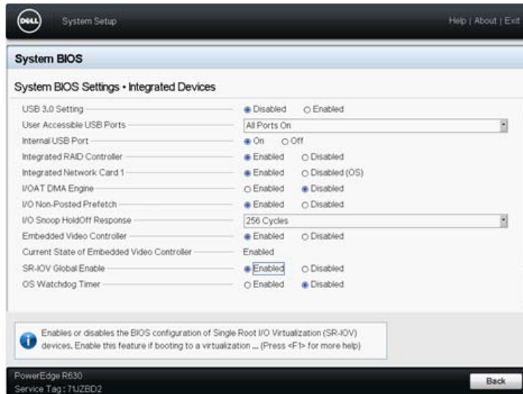
그림 8-1. SR-IOV 를 위한 시스템 설정 : 통합 장치
