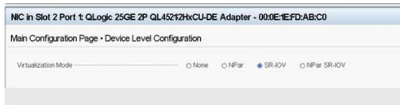
그림 8-2. SR-IOV 를 위한 시스템 설정 : 장치 레벨 구성
