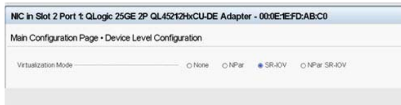
Abbildung 8-9. Systemeinrichtung für SR-IOV: Integrierte Geräte
