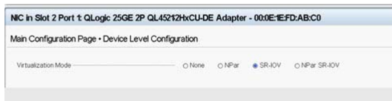
Abbildung 8-2. Systemeinrichtung für SR-IOV: Konfiguration auf Geräteebene
