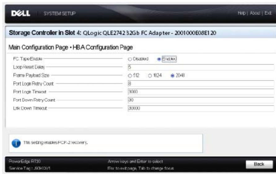
Ilustración 3-16. Dell System Setup: HBA Configuration (Configuración del sistema Dell: Configuración de HBA)
