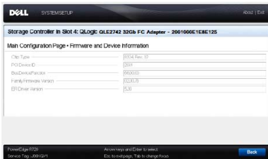
図 3-14. Dell セットアップユーティリティ：ファームウェアおよびデバイスの情報
