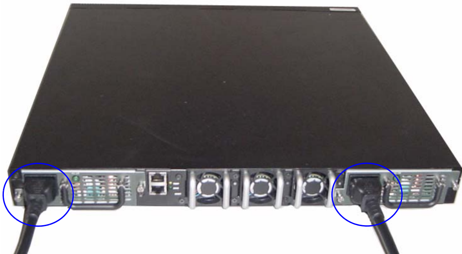
図 2 電源ケーブルの接続
