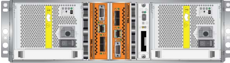
Figure 3-4 : Orientation correcte du module de contrôle
