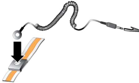
Figure 1-5 : Utilisation d'un bracelet antistatique
