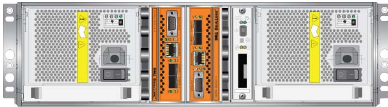
Figura 3-4: Orientación adecuada del módulo de control
