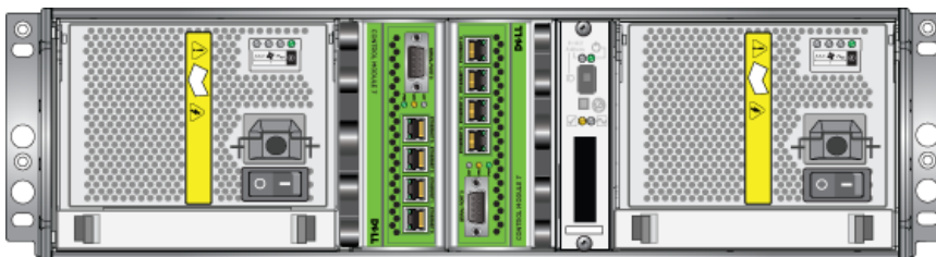
图 3-6: 正确的控制模块方向
