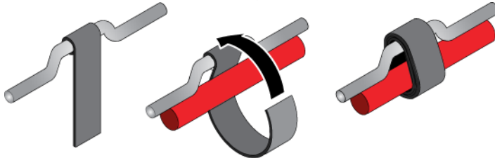
图 2-15: 扣紧粘扣束线带
