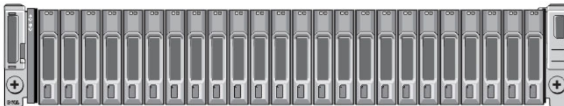
Рисунок 4. 2,5-дюймовый дисковый массив — вид спереди (без заглушки)
