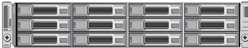
Рисунок 3. 3,5-дюймовый дисковый массив — вид спереди (без заглушки)
