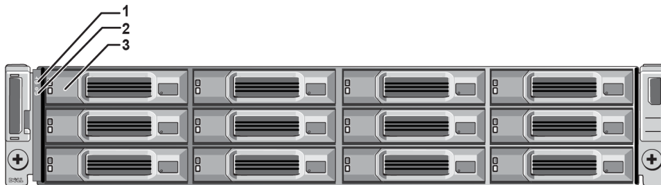
그림 4: 전면 패널의 특징 및 표시등(2.5인치 드라이브)
