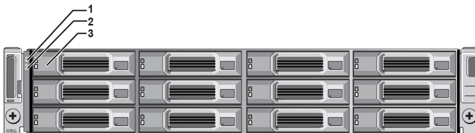
图 4: 前面板功能部件和指示灯(2.5 英寸驱动器)
