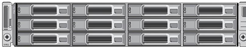
그림 3. 3.5인치 드라이브 어레이 - 전면 모습(베젤 없음)
