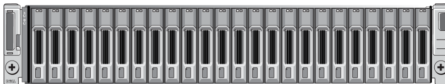
Abbildung 3: 2,5-Zoll-Laufwerkarray - Vorderansicht (ohne Blende)
