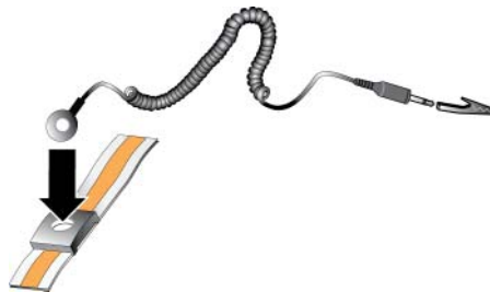
Ilustración 1 Uso de la muñequera electrostática
