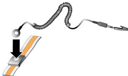
Figure 1 Utilisation d'un bracelet antistatique
