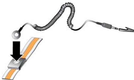
Figure 2-1 : Utilisation d'un bracelet antistatique
