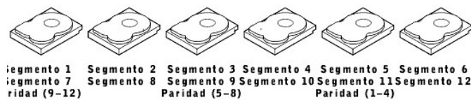
Ilustración 2-3. Ejemplo de paridad distribuida (RAID 5)
