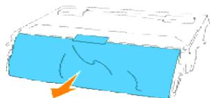
2. Per inserire la cartuccia a tamburo, spingere verso l'alto la leva sul lato destro della stampante. Con la leva in posizione sollevata, tenere la cartuccia a tamburo per la maniglia, allineare le frecce sulla cartuccia a tamburo con le frecce corrispondenti sulla stampante e inserire la cartuccia fino a farla scattare in posizione.
