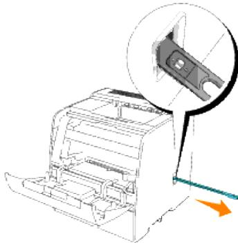
3. Spingere verso l'interno le due linguette del tampone per rimuoverlo.
