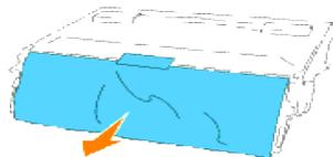
3. Per inserire la cartuccia a tamburo, spingere verso l'alto la leva sul lato destro della stampante. Con la leva in posizione sollevata, tenere la cartuccia a tamburo per la maniglia, allineare le frecce sulla cartuccia a tamburo con le frecce corrispondenti sulla stampante e inserire la cartuccia fino a farla scattare in posizione.
