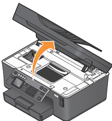
**Примечание.** Печатающая головка переместится в положение установки картриджа.
