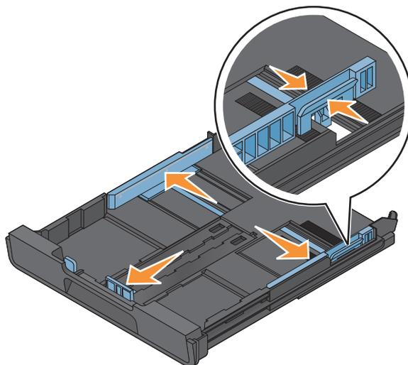
**3** При загрузке бумаги формата A4 или Legal сожмите фиксатор и потяните его, чтобы раздвинуть лоток.
