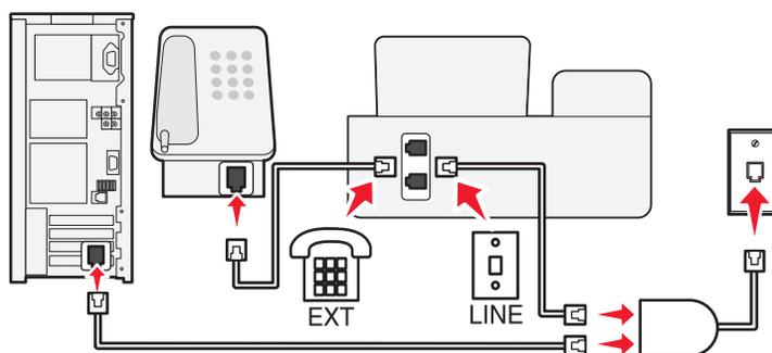
Линия DSL разделяет обычную телефонную линию на два канала: голосовой и Интернет. Сигналы телефона и факса передаются по голосовому каналу, а сигналы Интернета – по другому. Таким образом одну линию можно использовать для аналоговых голосовых вызовов (включая факсы) и для цифрового доступа в Интернет.
