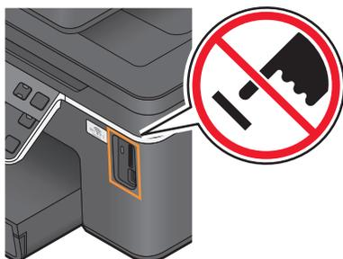
**Aviso: Danos potenciais:** Não toque em quaisquer cabos, em qualquer placa de rede, qualquer conector, placa Bluetooth USB ou na impressora nas áreas mostradas enquanto estiver a imprimir, ler ou escrever activamente a partir de um dispositivo compatível com Bluetooth. Poderá perder dados.
