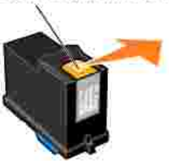
Inyectores de los cartuchos de tinta
