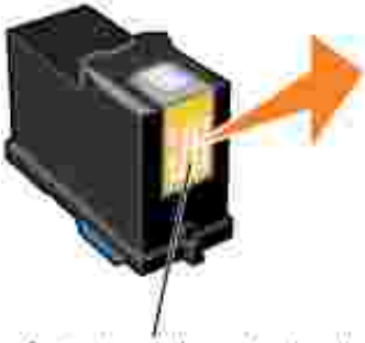
Contactos de los cartuchos de tinta
