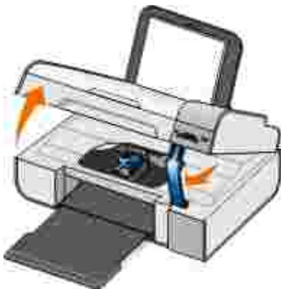
Il supporto delle cartucce di inchiostro viene spostato nella posizione di caricamento, a meno che la stampante non sia occupata.
