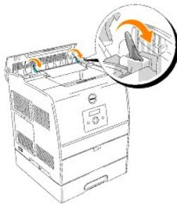
**AVVISO:** Non toccare in alcun caso le leve esterne posizionate su entrambe le estremità dell'unità del fuser, utilizzate per rimuovere o installare l'unità del fuser.
