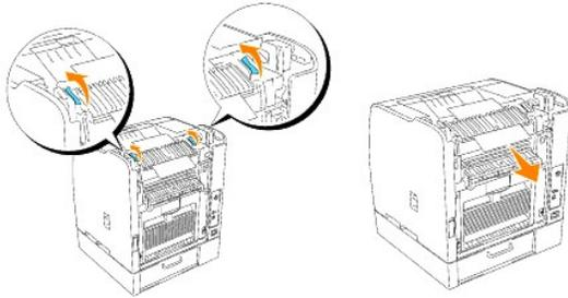
**NOTA:** Non toccare in alcun caso le leve esterne posizionate su entrambe le estremità dell'unità del fuser, utilizzate per rimuovere o installare l'unità del fuser.
