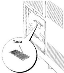
4. Spingere la scheda di memoria saldamente all'interno dell'alloggiamento.
