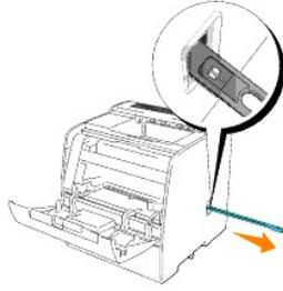
3. Spingere verso l'interno le due linguette del tampone per rimuoverlo.
