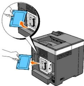
4. Con el conector de la memoria mirando hacia la ranura, inserte la de memoria verticalmente en la ranura.
