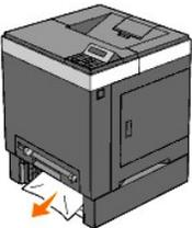
4. Abra la cubierta frontal pulsando el botón lateral y retire el papel atascado. Luego, asegúrese de que no queden restos de papel en el interior de la impresora.
