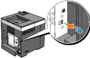
4. Inserte el adaptador de impresora inalámbrico en el conector correspondiente ajustando las dos patillas y el enganche del adaptador a la posición de los tres orificios situados en torno al conector del adaptador de impresora inalámbrico.
