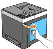
2. Pulse la traba(s) hacia atrás para desbloquear el cartucho o los cartuchos de tóner que desea sustituir.
