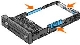
**NOTA:** Al cargar material de impresión especificado por el usuario, ajuste las guías de anchura y deslice la parte extensible de la bandeja apretando la guía de longitud y deslizándola hasta que repose ligeramente contra el borde de la pila de papel.
