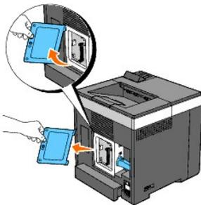
4. Retire el adaptador de impresora inalámbrico de la impresora liberando el enganche del mismo desde la parte inferior del zócalo del adaptador de impresora inalámbrico según se muestra en la siguiente ilustración.
