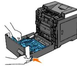
4. Retire el duplexador de la impresora levantándolo verticalmente y sujetándolo horizontalmente.
