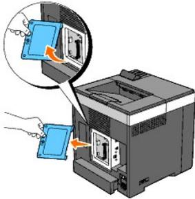
4. Inserte el adaptador de protocolo de red alineando las dos ranuras rectangulares y el orificio circular y asegúrese de que queda encajado en su sitio.
