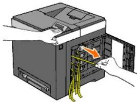
3. Pulse y deslice las trabas azules de los cuatro cartuchos de tóner hasta la posición de bloqueo.
