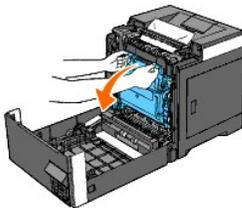
4. Levante las palancas de los extremos del fusor y retire el papel atascado. Si no puede encontrar el papel atascado, vaya al siguiente paso.
