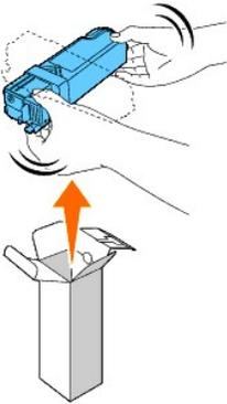
2. Inserte el cartucho de tóner en el portacartuchos correspondiente y deslice las trabas del cartucho de tóner hasta que éste quede perfectamente bloqueado.
