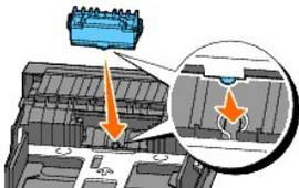
2. Inserte el rodillo de retardo en el eje hasta que encaje de forma que las protuberancias queden encajadas por completo en las ranuras y el gancho del rodillo repose de nuevo en la ranura del eje.
