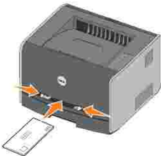
3. Segure o suporte de impressão de ambos os lados perto do alimentador manual e empurre-o na direcção da impressora até que esta o prenda automaticamente.
