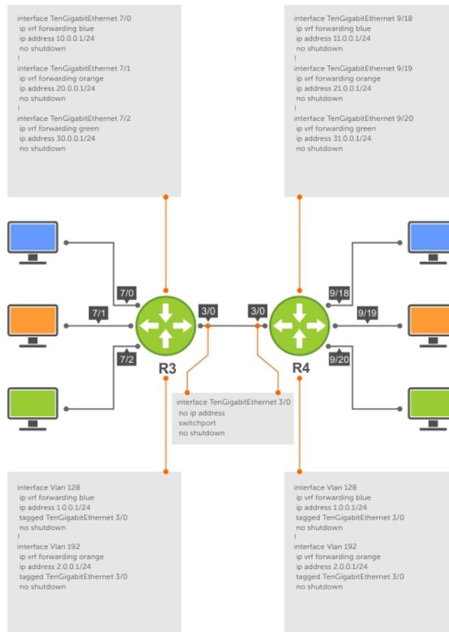
**Figure 144. Setup VRF Interfaces**
