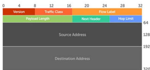
Figure 47. IPv6 Header Fields
