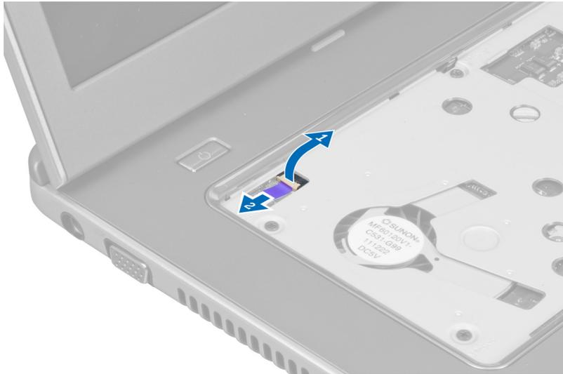
8. Sollevare la linguetta e sbloccare il cavo del touchpad, del lettore della scheda SD e dello scanner delle impronte dal computer.
