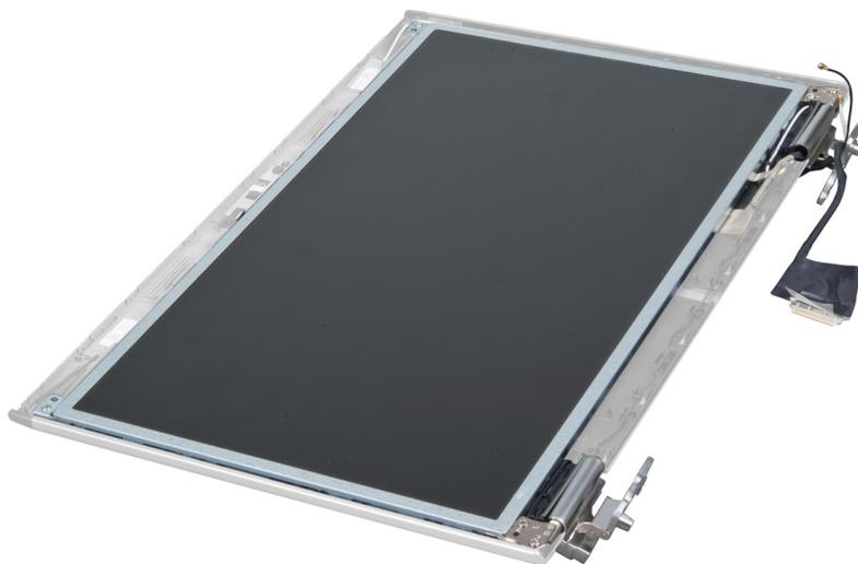
3. Rimuovere le viti che fissano i supporti dello schermo all'assemblaggio dello schermo.
