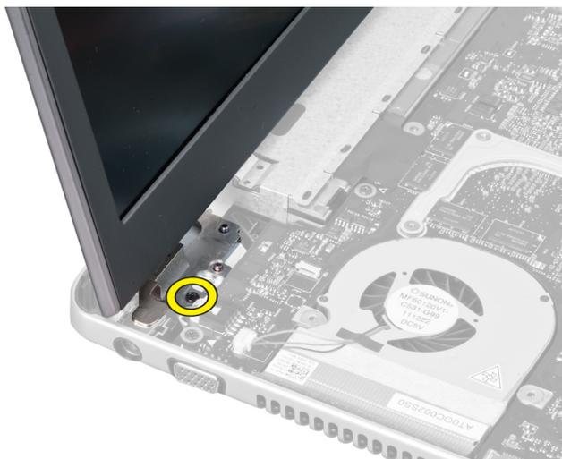
**6.** Sfilare il cavo della fotocamera e rimuovere la vite destra che fissa l'assemblaggio dello schermo al sistema.
