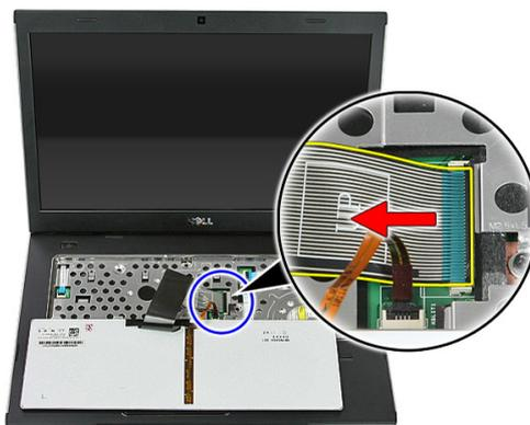
7. Si votre ordinateur est livré avec un clavier rétro-éclairé, ouvrez le clip de fixation du câble de rétro-éclairage du clavier.
