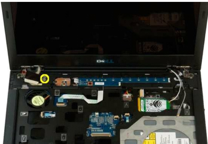
11. Lepas empat sekrup yang mengunci rangkaian display ke dasar komputer.
