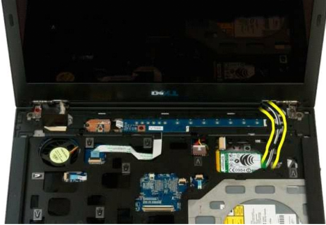
9. Lepas kabel data display dari board sistem.
