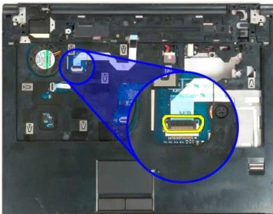
15. Lepas kabel data board tombol multimedia dari penjepit.
