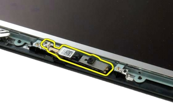
7. Lepas kabel data kamera display.
