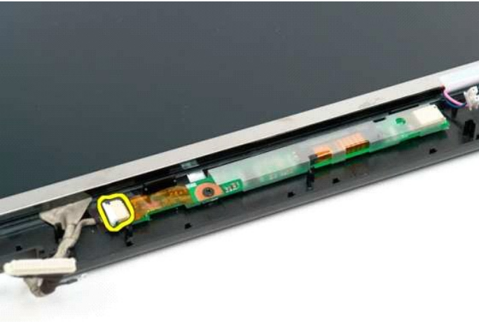
7. Lepas panel display LCD dari rangkaian display.
