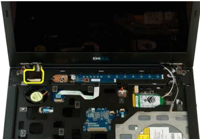
10. Longgarkan dan lepas sekrup grounding display dari komputer.
