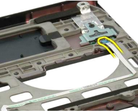
13. Lepas sekrup yang mengunci pelat penahan pembaca sidik jari ke sasis komputer.
