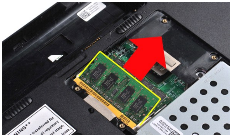
6. ทำตามสองขั้นตอนสุดท้ายเพื่อถอดโมดูลหน่วยความจำขั้นที่สอง : เช่นเดียวกัน ใช้งานคลิปที่ปลายสองด้านของช่องเสียบโมดูลหน่วยความจำจนกว่าโมดูลหน่วยความจำจะตั้งขึ้นมา
