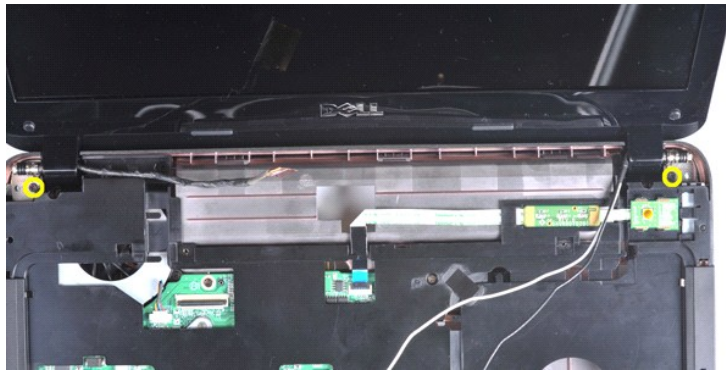
14. 케이블이 모두 분리되었는지 주의하면서 디스플레이 조립품을 들어 올려 컴퓨터에서 분리합니다.
