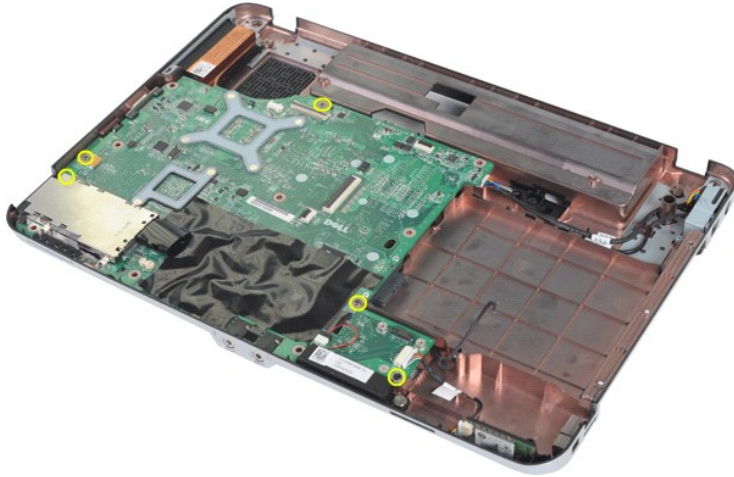
17. 시스템 보드의 커넥터에서 스피커 및 Bluetooth® 케이블을 분리합니다.
