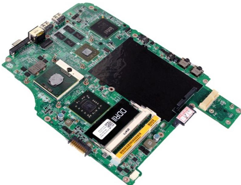
18. À l'aide d'un petit tournevis à lame plate, faites tourner la vis à cames du support ZIF dans le sens contraire des aiguilles d'une montre jusqu'à arrêt des cames.
