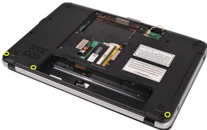
4. Ôtez les clips du capot du panneau de commande qui se trouvent dans le logement de la batterie.
