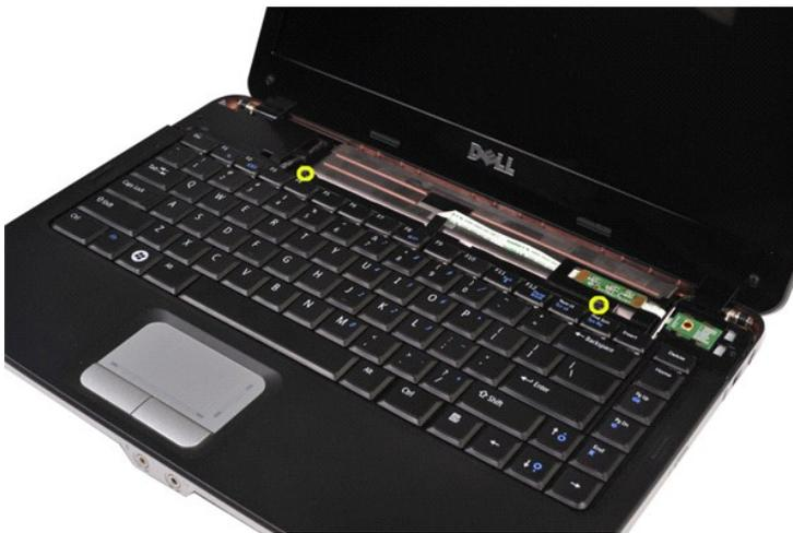
5. Retournez le clavier et posez-le sur le repose-mains. Assurez-vous de ne pas faire pression sur le câble du clavier se trouvant sur la partie inférieure du clavier.
