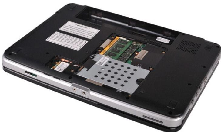
4. Du bout des doigts, écartez avec précaution les clips de fixation situés à chaque extrémité du premier connecteur du module de mémoire jusqu'à ce que le premier module sorte.
