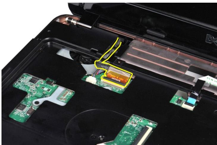
13. Retirez les deux vis de fixation de l'ensemble écran de la partie inférieure de la base de l'ordinateur.
