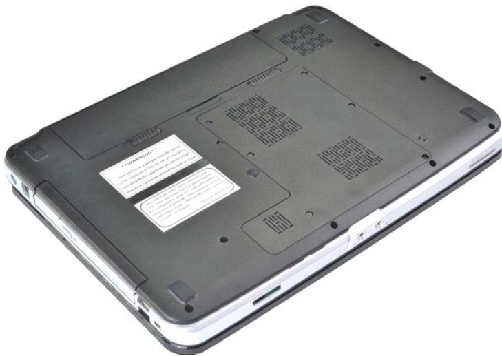
2. Glissez les loquets de la batterie tout en introduisant vos index dans la rainure au centre de la batterie et en tirant pour désengager la batterie de l'ordinateur.
