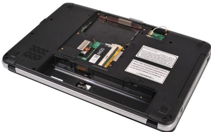
3. Retirez les trois vis du capot du panneau de contrôle de la partie inférieure de l'ordinateur.
