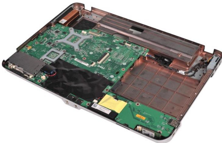
10. Retirez les deux vis fixant la carte d'E/S au châssis de l'ordinateur.
