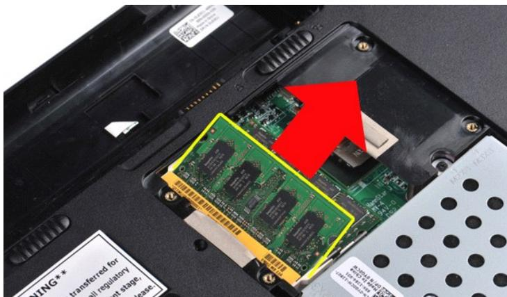
6. Répétez les deux dernières étapes pour retirer le second module de mémoire : écarter à nouveau les clips de fixation situés à chaque extrémité du connecteur du module de mémoire jusqu'à ce que le module sorte.
