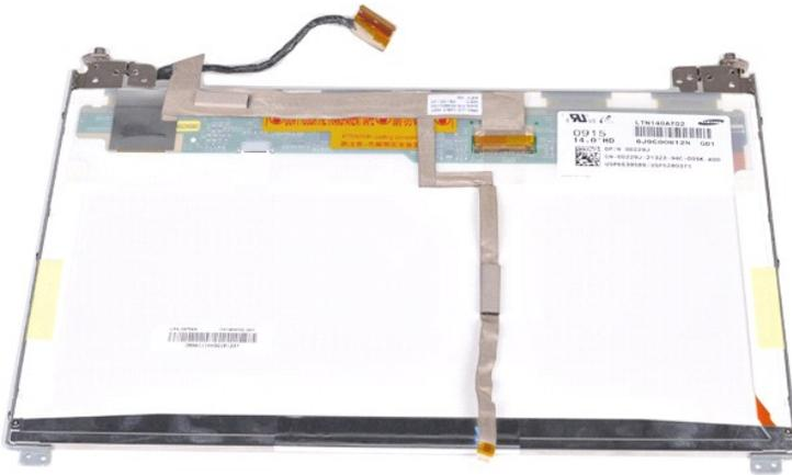
12. Débranchez et retirez soigneusement le câble de l'inverseur de l'écran du panneau LCD de l'écran.
