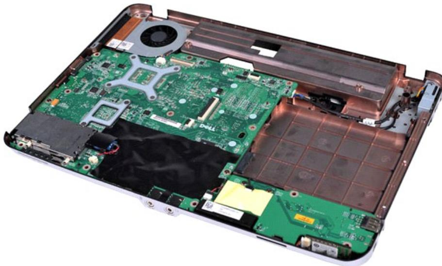
10. Débranchez le câble du ventilateur du processeur du connecteur sur la carte système.
