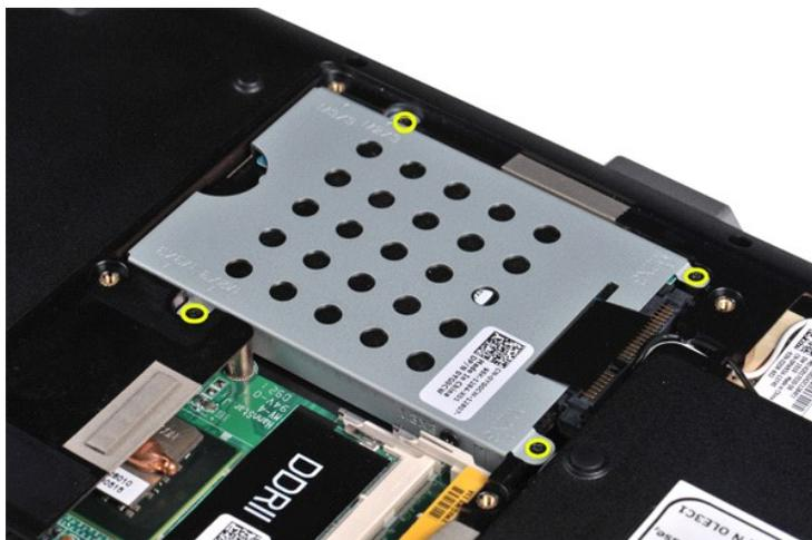
5. Poussez la languette en plastique vers l'autre extrémité de l'ensemble disque dur pour désengager l'interposeur du disque dur du connecteur sur la carte système, puis soulevez l'ensemble disque dur de l'ordinateur.
