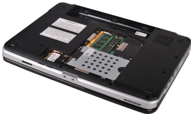
4. Retirez les quatre vis fixant l'ensemble disque dur à l'ordinateur.
