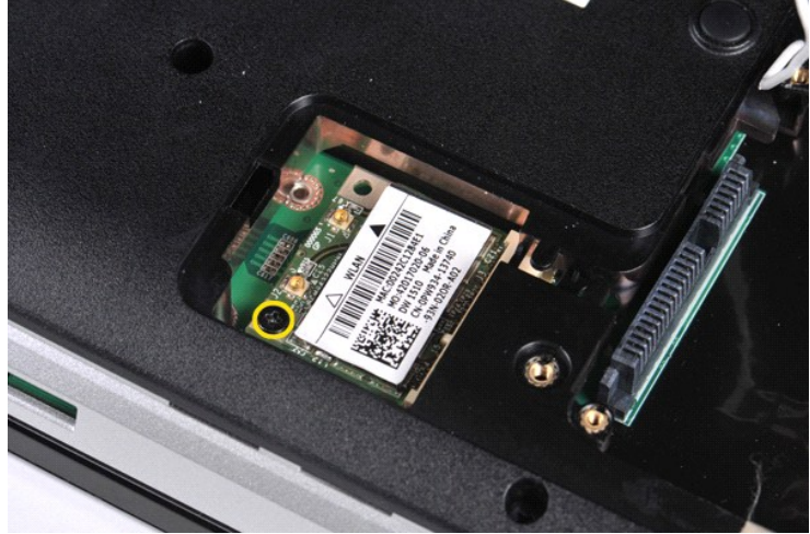
6. ارفع بطاقة الشبكة المحلية اللاسلكية (WLAN) من الكمبيوتر.
