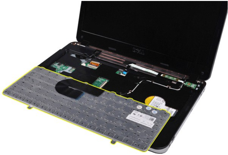
7. قم بإزالة لوحة المفاتيح من الكمبيوتر.
