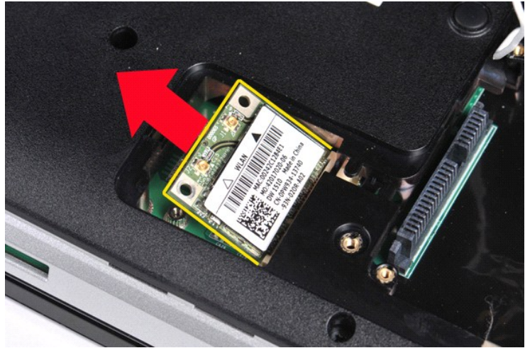
6. ارفع بطاقة الشبكة المحلية اللاسلكية (WLAN) من الكمبيوتر.
