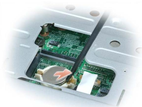
Quando si reinsertisce la batteria, inserirla con un'inclinazione di 30 gradi sotto il fermaglio con il lato positivo (contraddistinto da un segno più [+]) rivolto verso l'alto, quindi spingerla in posizione.
